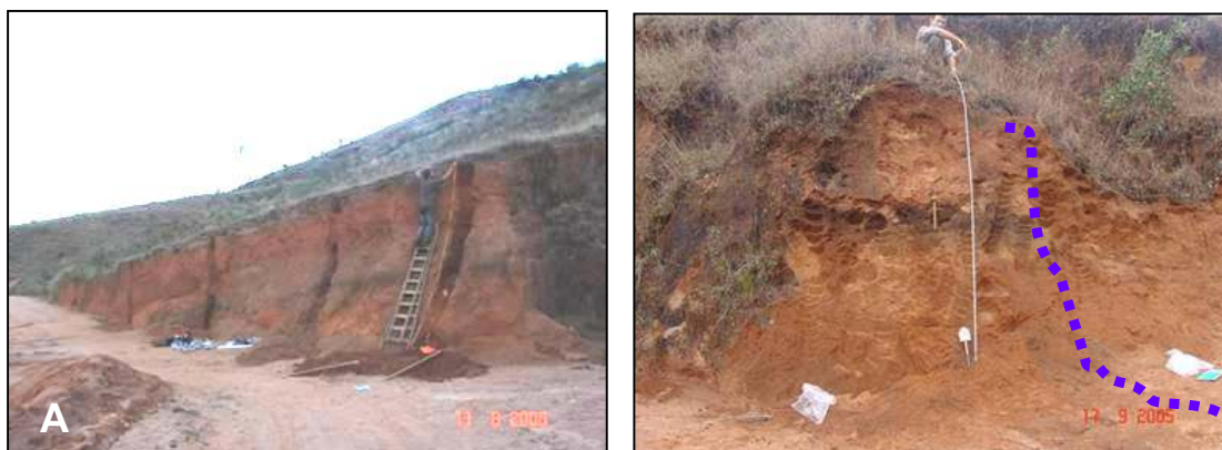
Figura 42. Foto A: execução do perfil nivelado em depósito, com nível confinado de matéria orgânica. Detalhe para início da ravina ao lado da escada. Foto B: em tracejado, limite da paleo-ravina que interrompe o nível de matéria orgânica.
