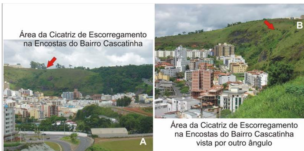
Figura 21: A fotografia A e B são referentes ao bairro Cascatinha e representam a mesma encosta, porém vistas por ângulos diferentes. Encosta de geometria côncava em perfil e planta, de solos rasos com alguns afloramentos, ambiente típico de escorregamentos rasos.
