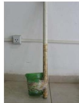
**Figura 19:** Fotografias do procedimento de coleta das sub-amostras de sedimentos escoados à esquerda e detalhes de instrumentos de coleta, observado a direita.
