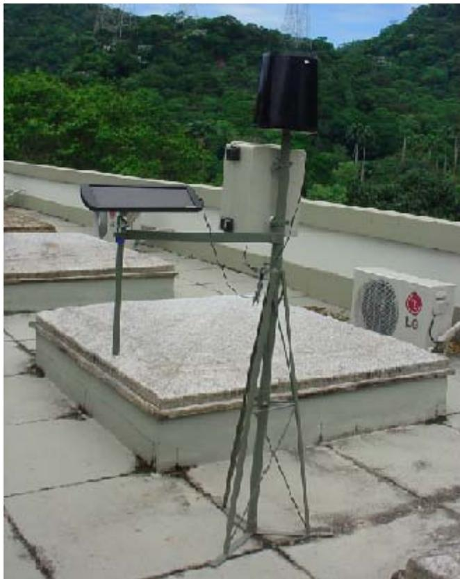
**Figura 15:** Pluviômetro digital instalado na bacia estudada.
