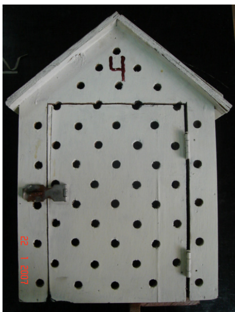
Figura 5.3 – Abrigo onde se posicionaram os Data Loggers utilizados nas medições no Estádio
