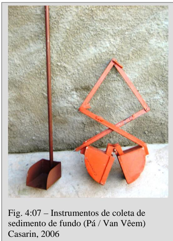
Fig. 4:07 – Instrumentos de coleta de sedimento de fundo (Pá / Van Vêem) Casarin, 2006
