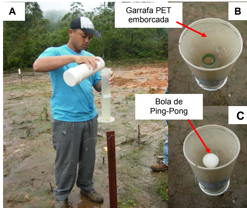
Figura 15 – (A) Leitor de campo realizando a mensuração do volume de chuva. Estrutura dos pluviômetros cilíndricos, evidenciando a estrutura interna com a garrafa de PET emborcada (B) e a bola de ping-pong (C) utilizada para evitar a evaporação da água coletada.
