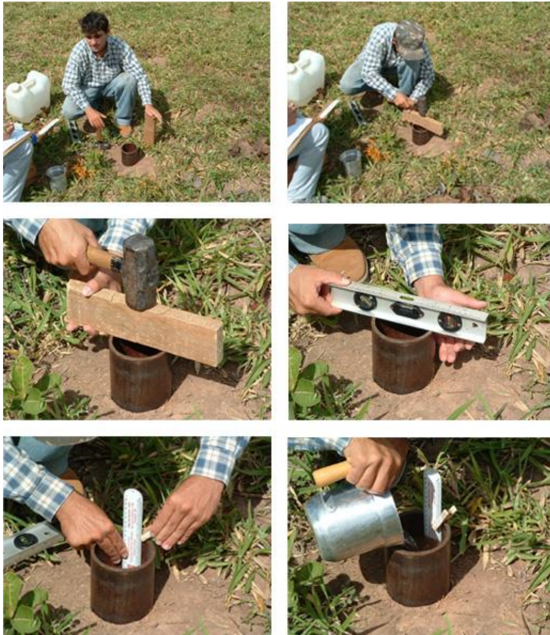
Figura 25. Seqüência dos ensaios de infiltração executados. Fotos do autor, 2003.
