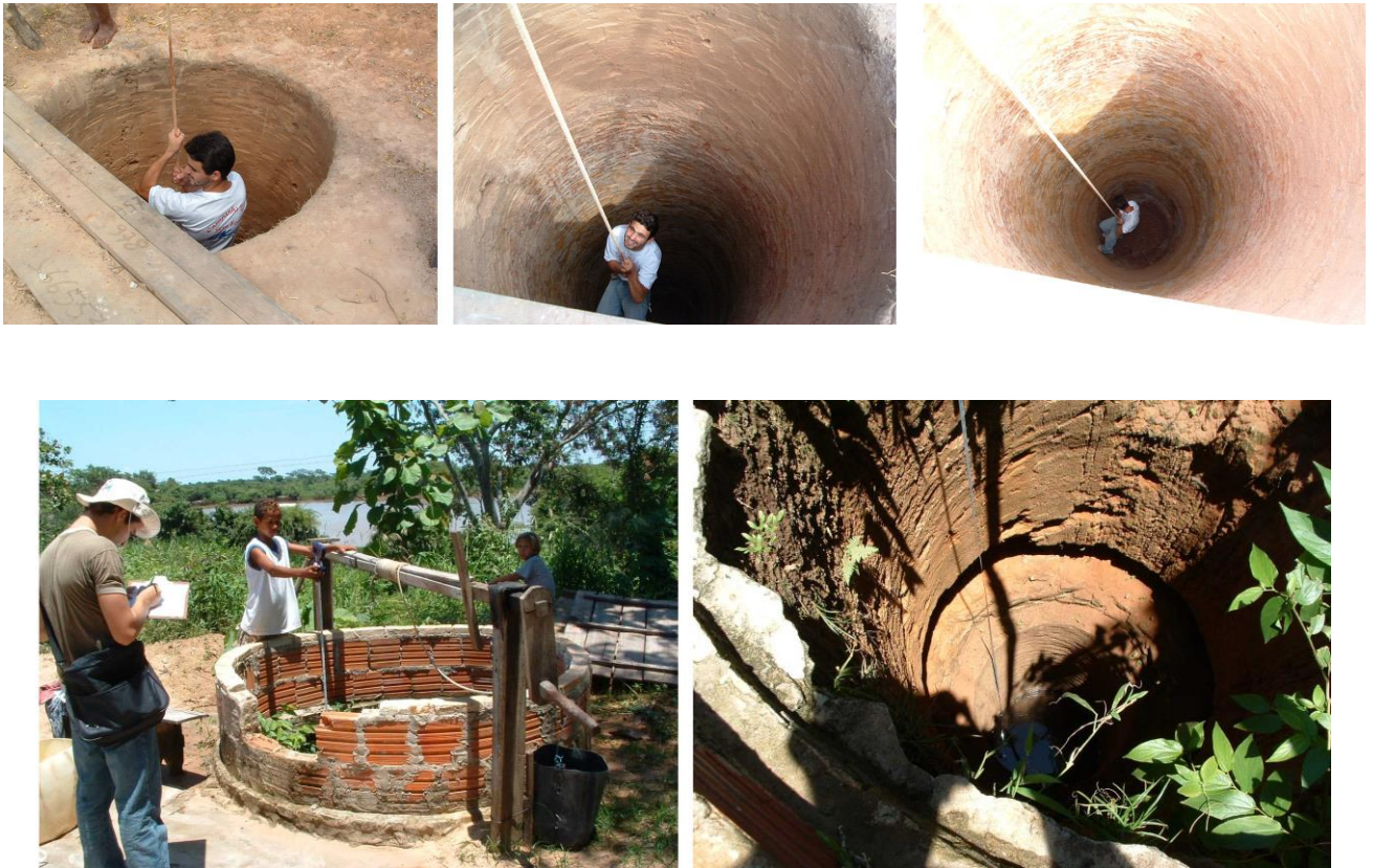
Figura 20. Etapas da execução e análise dos poços de sondagem de solo. Fotos do autor, 2003.
