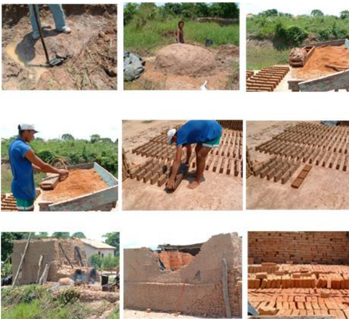
Figura 40. Etapas da fabricação de tijolos em olarias próximas ao Canal dos Fontes, no
