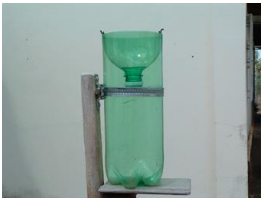
Figura 24. Pluviômetro artesanal feito com garrafa PET. Foto do autor, 2003.
