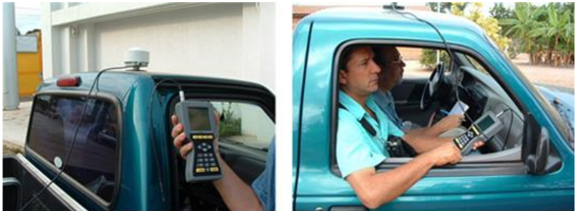
Figura 23. Levantamento topográfico com utilização de GPS topográfico e veículo. Fotos do autor, 2003.
