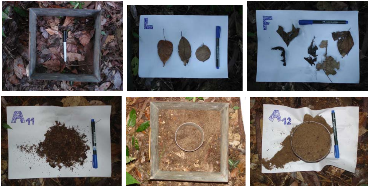
Figura 4.1. acima, da esquerda para direita: quadrado metálico de 25cm de lado; exemplares de folhas da camada L; exemplares de folhas da camada F. Abaixo, da esquerda para direita: exemplar de amostra de solo do horizonte A 1 ; cilindro metálico de 10cm de altura por 10cm de diâmetro; exemplar de amostra de solo do horizonte A 1 .
