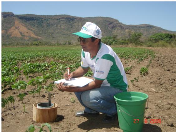
Figura 04 – Teste de infiltração do solo com o uso de infiltrômetro de anéis concêntricos, realizado em Plintossolo sob cultura de feijão irrigado, Fazenda Vargem Grande, município de Palmas (TO).
