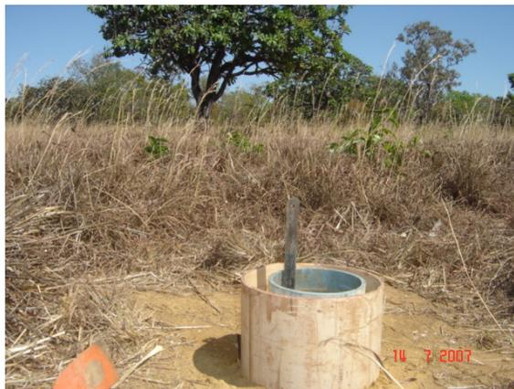
Figura 73 – Vista geral da área de ocorrência de Plintossolo Pétrico em área pastagem (Andropogon) na Fazenda Jatobá, detalhe para o infiltrômetro de anéis concêntricos, Bacia do Ribeirão São João, município de Porto Nacional.
