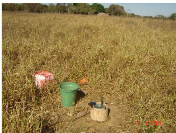
Figura 72 – Vista geral da área de ocorrência de Latossolo Vermelho-Amarelo em área pastagem (brachiária) no imóvel quinhão 31, detalhe para o infiltrômetro de anéis concêntricos, Bacia do Ribeirão São João, município de Palmas – TO.
