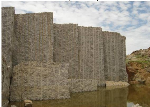
Figura 23 – Vista parcial de área de exploração mineral da rocha granítica para produção de blocos, detalhe para acumulação de água. Bacia do Ribeirão São João, município de Palmas – TO.
