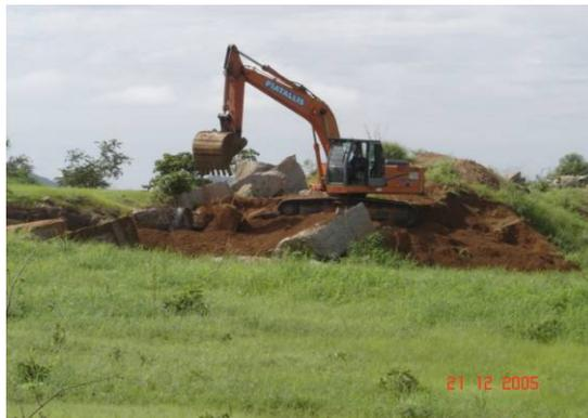
Figura 22 – Equipamento em atividade para a extração de blocos de granito - Projeto de Assentamento São João, município de Palmas – TO.
