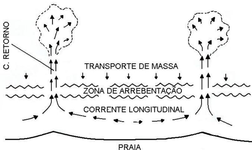
Figura 4.12: Esquema de uma célula de circulação, com suas correntes de retorno e correntes longitudinais (Modificado de Muehe, 1998a).
