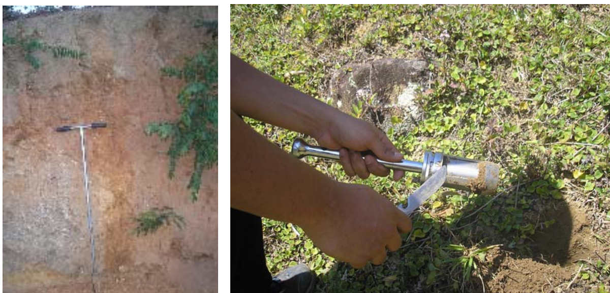
Figura 16 a e b. Trado holandês (a) e coletor volumétrico de amostras (b), respectivamente (Lagesolos, 2007).
