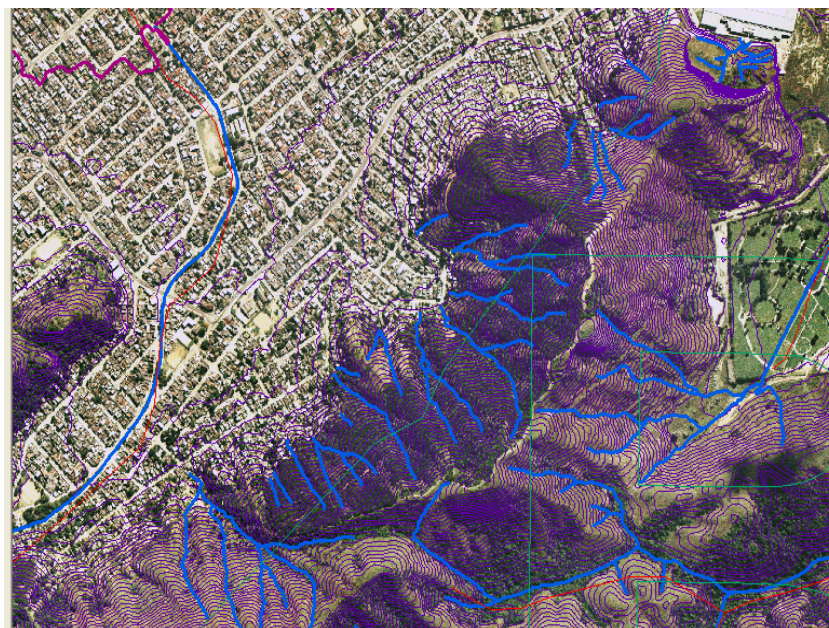
Figura 19: Em azul temos os canais de drenagem que não são visíveis na base topográfica porque ao atingirem a área urbanizada foram canalizados.
