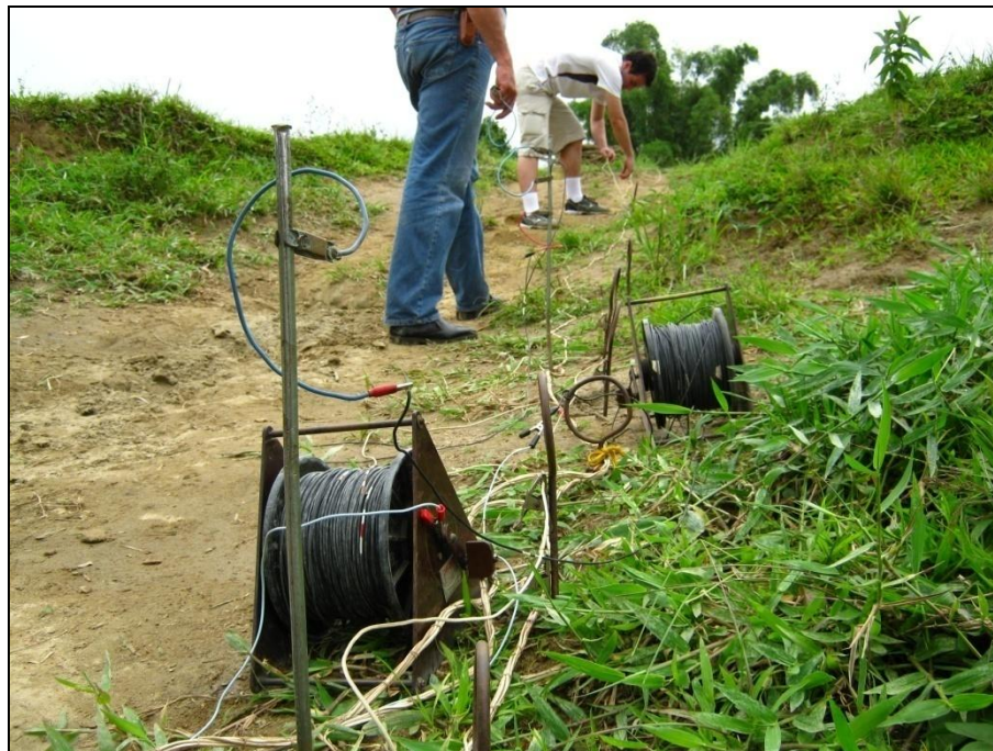
Figura 15: (a) eletrodos de corrente – que transmitem corrente elétrica para a subsuperfície do terreno, (b) carretéis de fios elétricos - ligados ao amplificador de corrente de um lado e do outro aos eletrodos fincados no chão, (c) eletrodos que recebem a corrente de retorno (Foto: S.L.S. SILVA, 2009).
