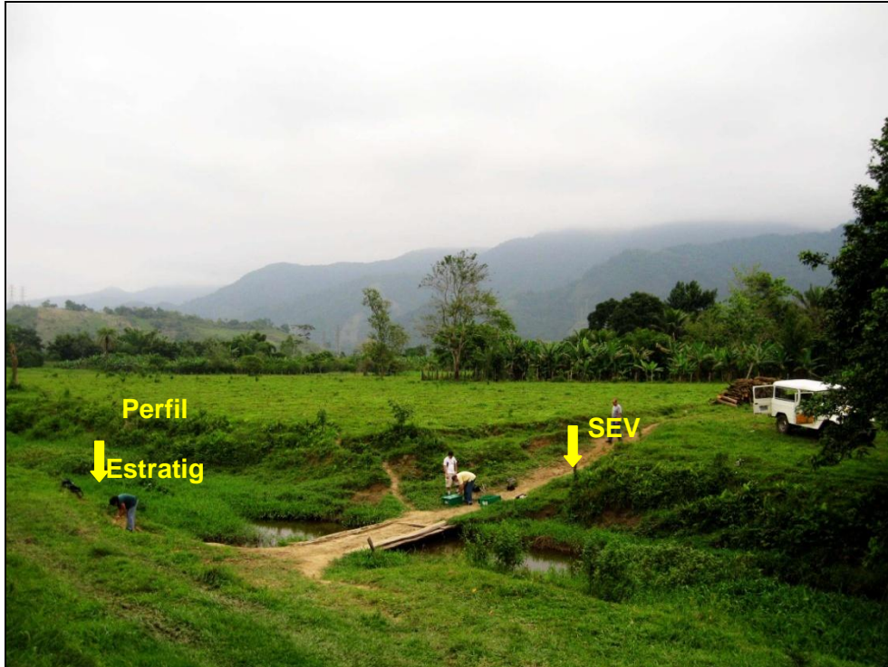
Figura 16: Foto mostrando a localização de perfil estratigráfico em parede exposta e coleta de amostras de solo para análise em laboratório; localização da primeira estação de coleta de dados por Sondagem Elétrica Vertical (SEV-2) - Foto: T.M. SILVA, 2009.
