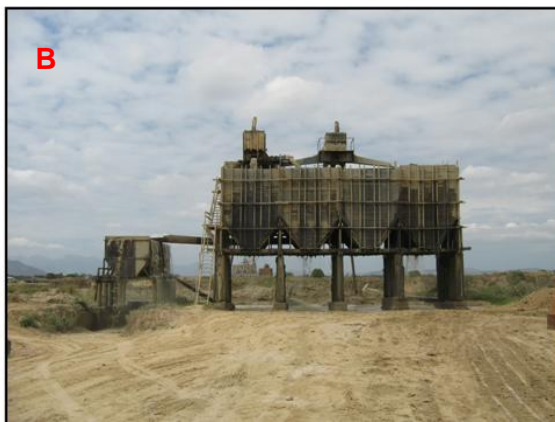
Figura 10: Etapas da extração de areia em ambiente de cava no areal Tropicaliente - (A) Localização do Areal Tropicaliente, na bacia do Guandu; (B) logo após a areia misturada com a água é bombeada para caixas suspensas; onde (C) a seleção granulométrica é feita pela desagregação das partículas através de lavagem (Fotos: T. M. Silva, 2008).
