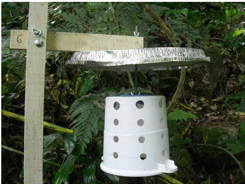
Figura 16: Abrigo para *datalogger*.
