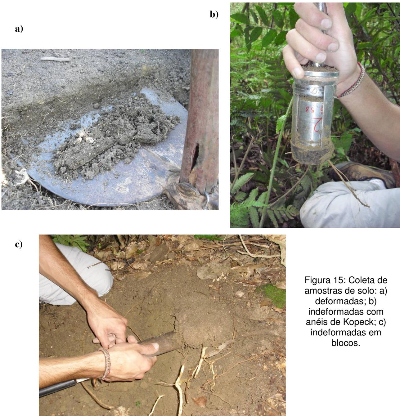
Figura 15: Coleta de amostras de solo: a) deformadas; b) indeformadas com anéis de Kopeck; c) indeformadas em blocos.
