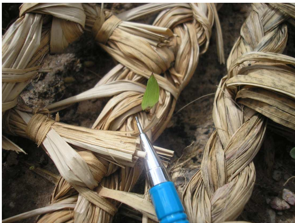
Figura 69 – Início do crescimento da cobertura de gramíneas, com geotêxteis de buriti servindo como mulch . Foto: Bezerra, 2009.
