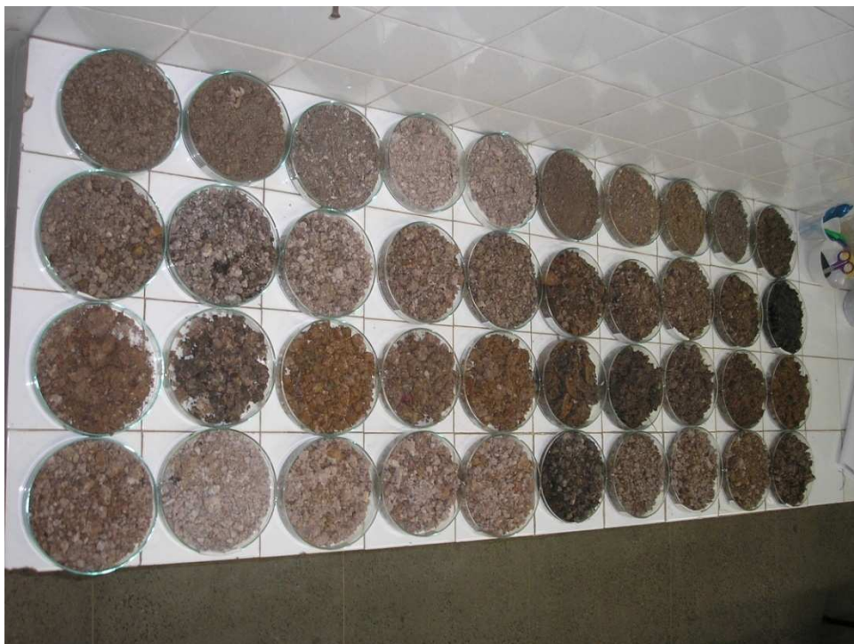
Figura 5 – Amostras de solos superficiais (cinco cm) provenientes das parcelas com geotêxteis com gramíneas e solo exposto. Foto: Bezerra, 2009.
