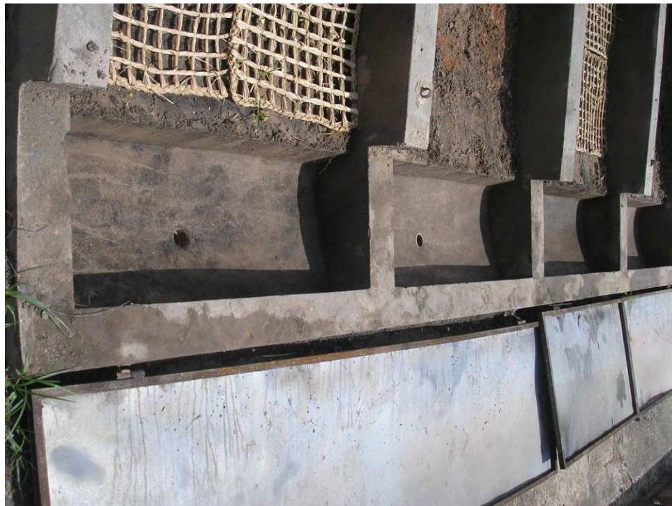
Figura 20 – Calhas coletoras de sedimentos na estação experimental. Foto: Bezerra, 2009.
