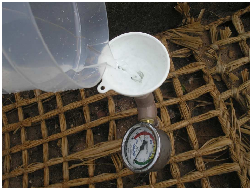
Figura 18 – Preenchimento de água nos tensiômetros.
