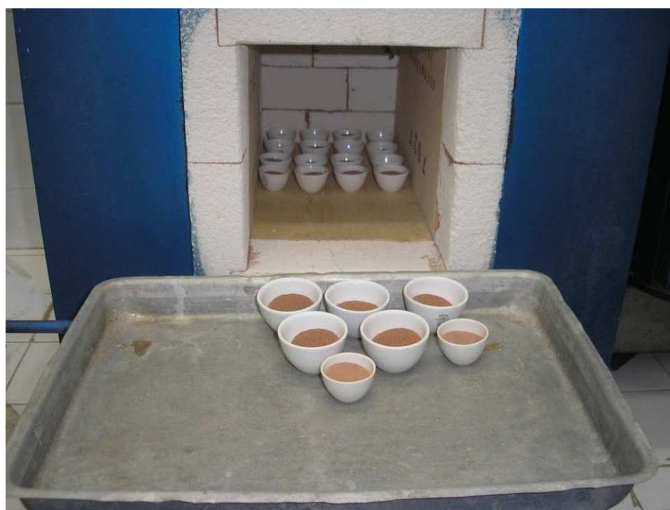
Figura 26 – Queima da matéria orgânica nas amostras no forno mufla.
