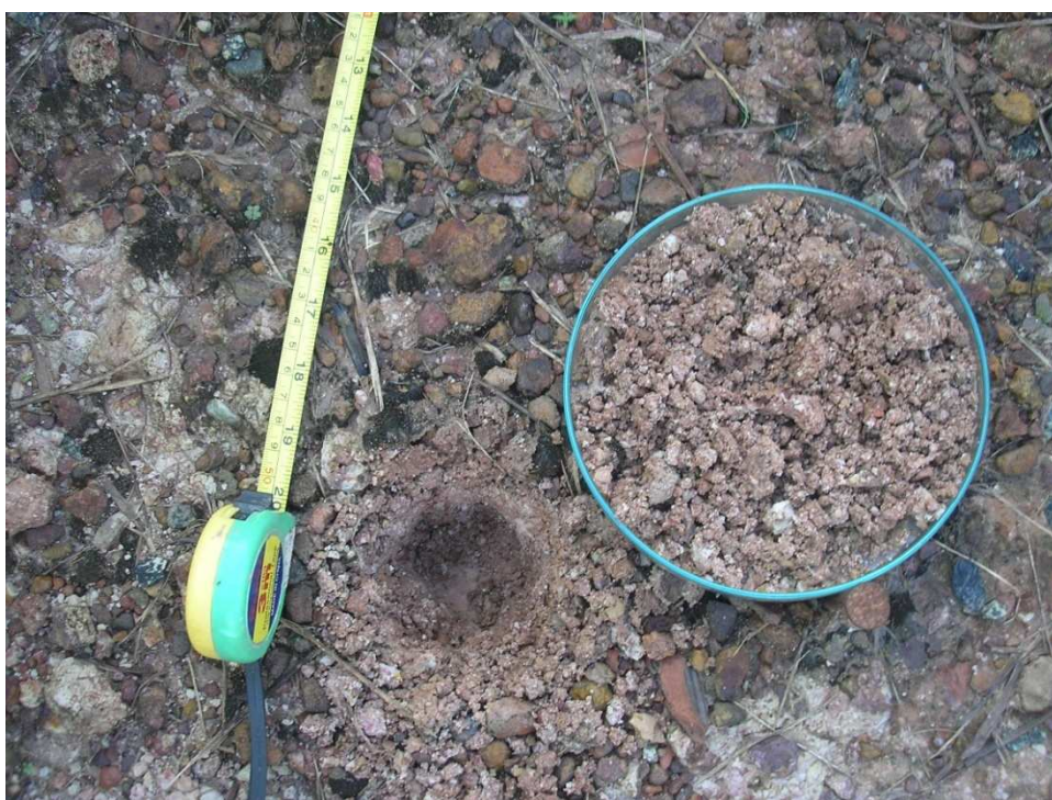
Figura 4 – Coleta das amostras na profundidade de 5 cm na parcela com solo exposto b. Foto: Bezerra, 2009.
