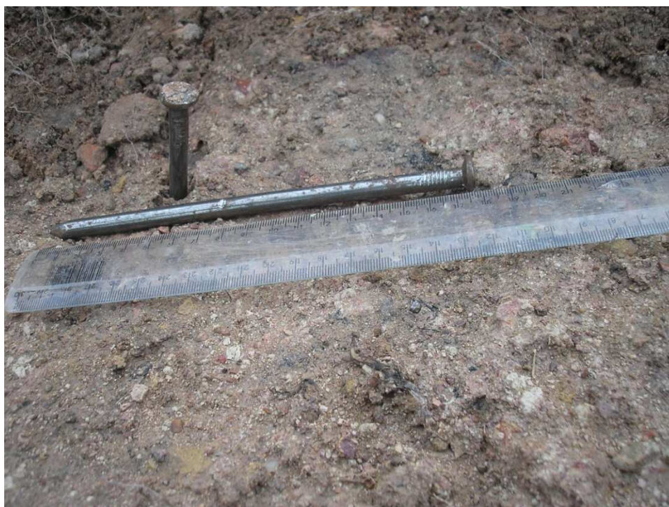
Figura 16 – Pinos de erosão (Pregos) com 20 cm de comprimento.
