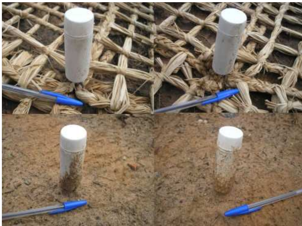
Figura 93 – Diferenças no efeito splash nas parcelas com geotêxteis e solo exposto no início do monitoramento da estação experimental. Foto: Bezerra, 2009.
