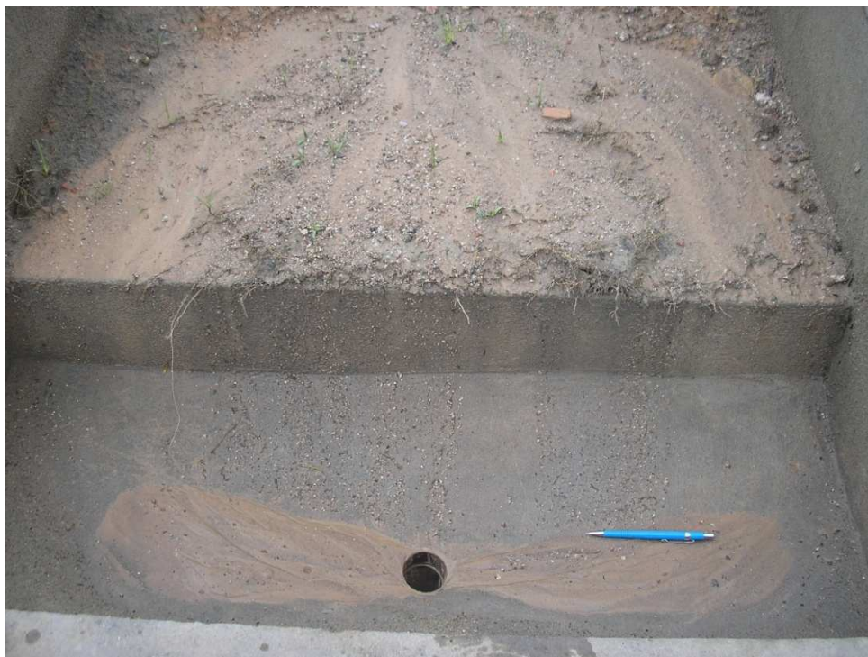
Figura 95 – Sedimentos depositados na calha da parcela com solo exposto.
