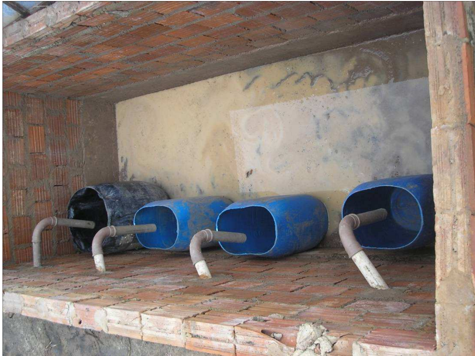
Figura 19 – Diferentes galões para o monitoramento do escoamento superficial e perda de sedimentos. Foto: Bezerra, 2009.
