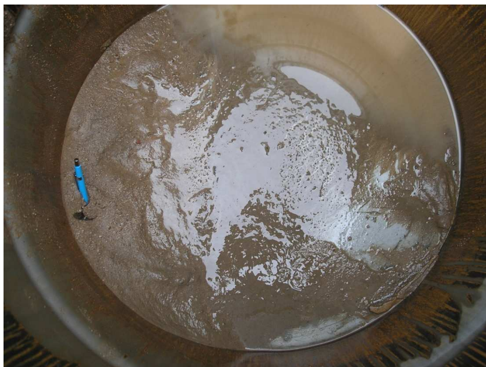
Figura 94 – Sedimento transportado para o galão da parcela com solo exposto b. Foto: Bezerra, 2009.
