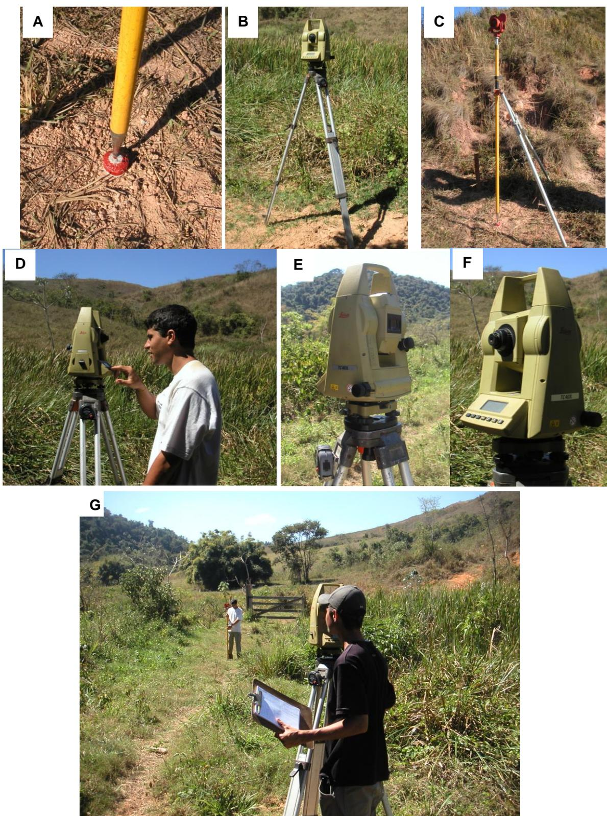
**Figura 46** – A) Detalhe do marco de apoio ao levantamento topográfico; B) Estação Total; C) Prisma refletor que serve para captar o ponto que se deseja obter; D) Operação da estação total; E e F) Detalhes da Estação Total e G) Exemplo da obtenção de um ponto.
