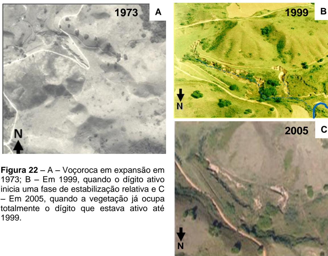
**Figura 22** – A – Voçoroca em expansão em 1973; B – Em 1999, quando o dígito ativo inicia uma fase de estabilização relativa e C – Em 2005, quando a vegetação já ocupa totalmente o dígito que estava ativo até 1999.
