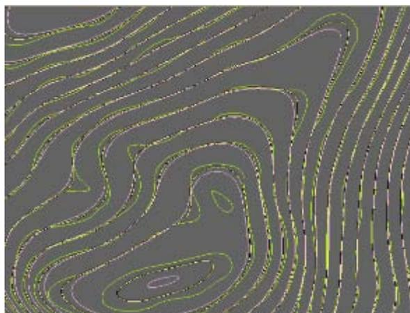
Figura 27: Ilustração da suavização das curvas de nível originais (linha verde), com filtro passa baixa 21x21, uma iteração (linha amarela) e com duas iterações (linha rosa).
