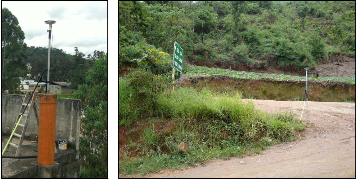
Figura 5.2 e 5.3 – Aparelho de DGPS instalado na estação geodésica de Nova Friburgo e aquisição das coordenadas do ponto de controle número 2, respectivamente. Fonte: Mendes (2010).
