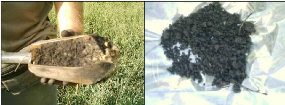
Figura 3.10. Esquerda: coleta de solo com um trado; direita: Solo misturado (turfa) que anteriormente era coletado para datação.
