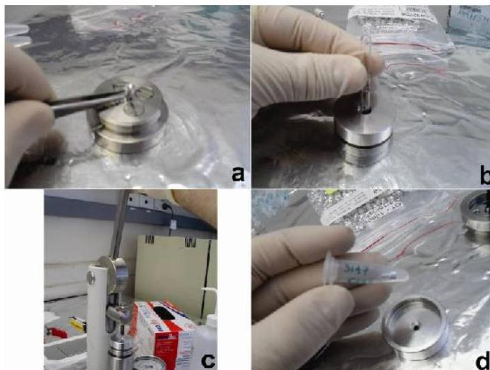
Figura 4.22. a) colocação do suporte do cadinho de alumínio dentro do suporte; b) Fe grafitizado é inserido no cadinho por meio do suporte; c) a abertura do cadinho é fechada com uma vareta de alumínio sob pressão; d) o cadinho é guardado em um recipiente plástico fechado, e encaminhado para o AMS.
