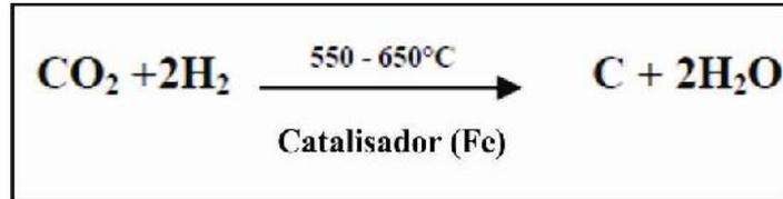
A reação acontece em duas reduções sucessivas: primeiramente, para monóxido de carbono, e, em seguida, para carbono, que permeia e adere à superfície do pó de ferro (catalisador). A pressão produzida durante a reação depende da quantidade de CO<sub>2</sub> e H<sub>2</sub> em resposta ao aquecimento pelas estufas, como pode ser visto na figura 4.21.
