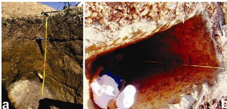
**Figura 4.3. a) Trincheira de ~0,90m em substrato quartzítico. Detalhe para nível de camada orgânica, logo acima do saprolito; b) Trincheira de ~2,5m em substrato de gnaiss, feita de forma escalonada, com degrau no fundo da dolina, apresentando um degradê de cores alaranjadas, avermelhadas e totalmente escuras no fundo, que representam a camada de matéria orgânica que cobre o saprolito.**
