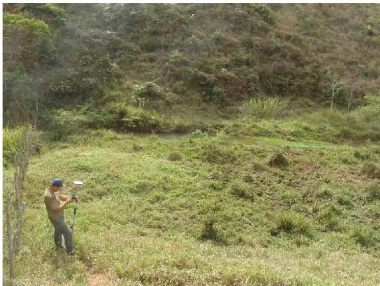
**Figura 4.6. Utilização do GPS diferencial em modo “Stop and Go” para o nivelamento das superfícies de terraço em fundos de vale.**
