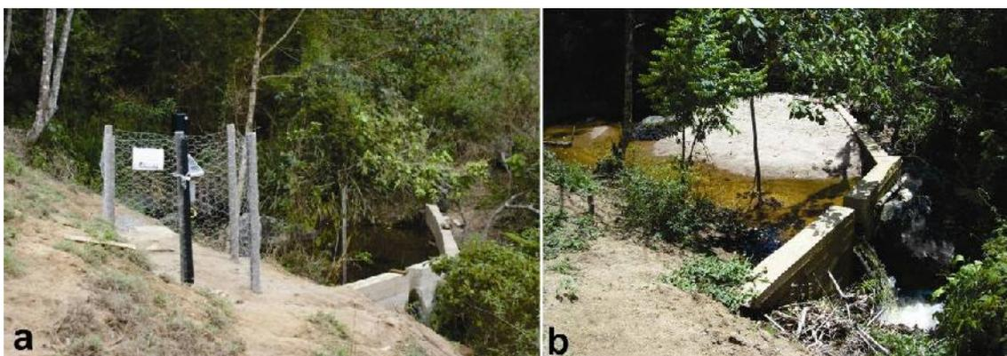
**Figura 3.19 - Estação pluvio-fluvio-sedimentográfica instalada na bacia do córrego Coelho, em litologia de quartzito grosseiro. A localização é representada no polígono amarelo de oeste na figura 3.18). a. estação funcionando em agosto de 2009; b. vertedouro soterrado por areias grosseiras em 20 de janeiro de 2010.**
