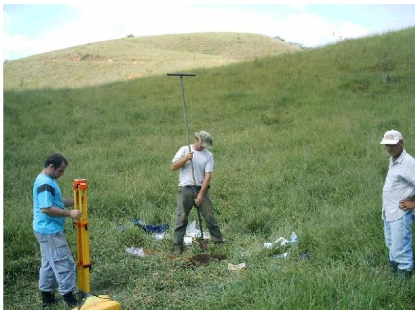
**Figura. 4.8** Ao centro, tradagem para a verificação dos limites dos pacotes sedimentares; à esquerda, montagem da estação total para mapeamento 1:500 (Uagoda, 2006).
