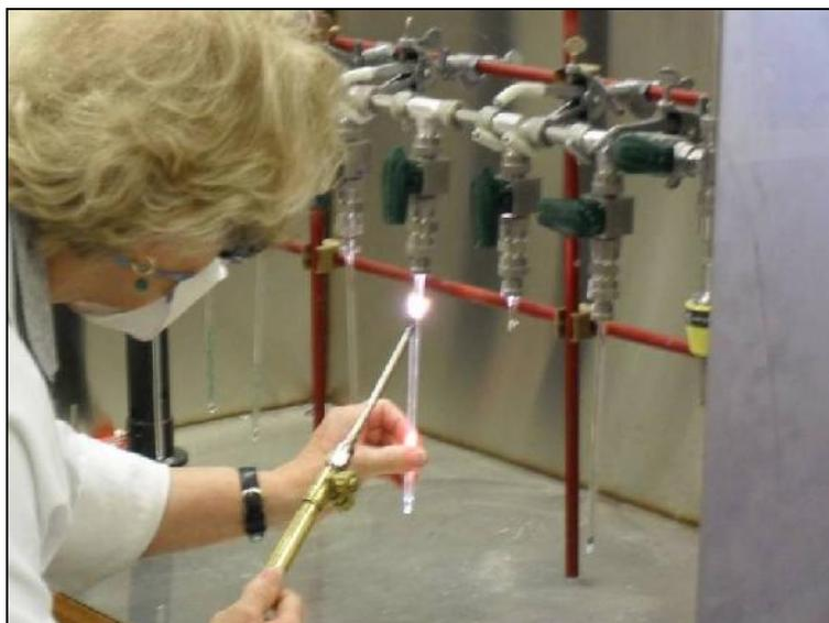
Figura 4.14. Selagem de tubos de quartzo em uma linha de vácuo.
