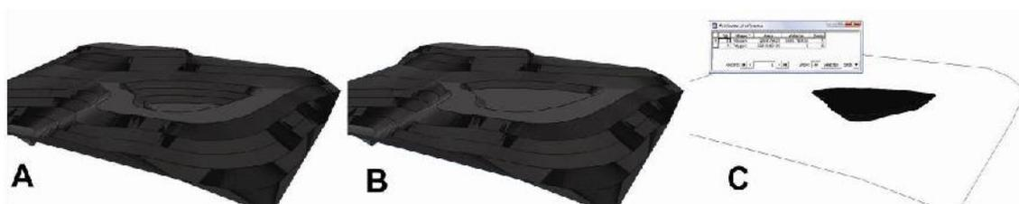
**Figura 4.9.** A. superfície base da dolina (fundo rochoso); B; superfície atual (topo do pacote sedimentar); C. diferença entre as duas superfícies, com detalhe para o cálculo da área e volume do pacote sedimentar individualizado.
