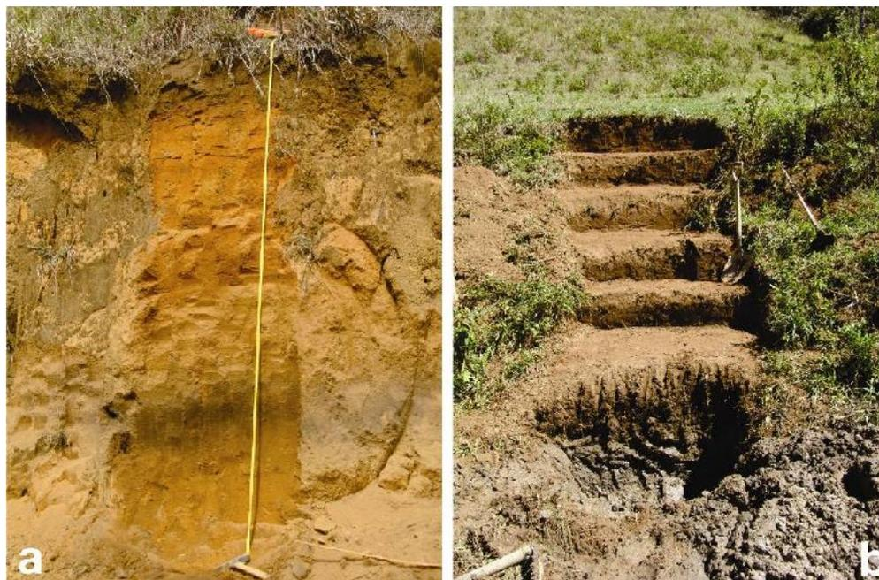
**Figura 4.1. a) Parte de perfil de estrada (~1,7m) em substrato de quartzito impuro; b) abertura de perfil escalonado em depósito de fundo de vale, em substrato de gnaisse.**
