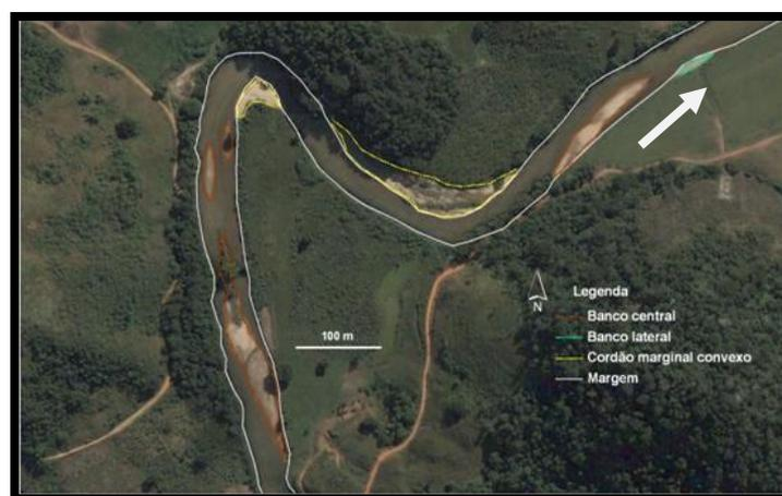
Figura 5-19: Feições deposicionais do tipo barras centrais e barras laterais. Fonte: Google Earth™.
