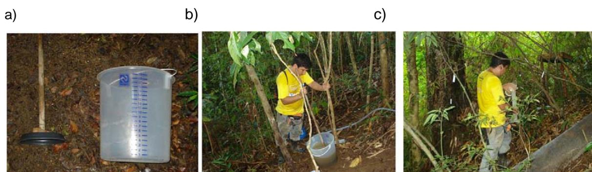
**Figura 4.2.3.4:** Material de coleta e mensuração do escoamento superficial, interceptação e produção de sedimentos; (a) balde e agitador artesanal; (b) homogeneização do total de sedimentos escoado; (c) coleta de sub-amostra de sedimentos transportados.
