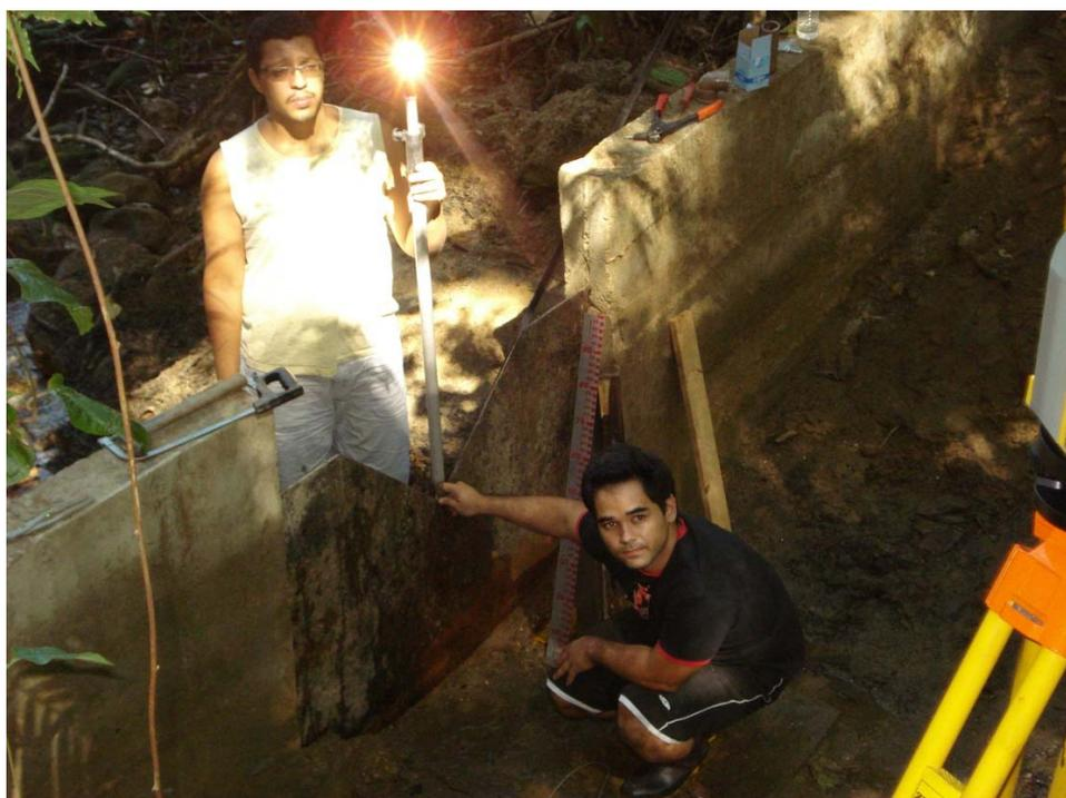
**Figura 4.3.1.1:** Etapa de nivelamento de precisão da régua linimétrica em relação ao vértice do vertedouro.
