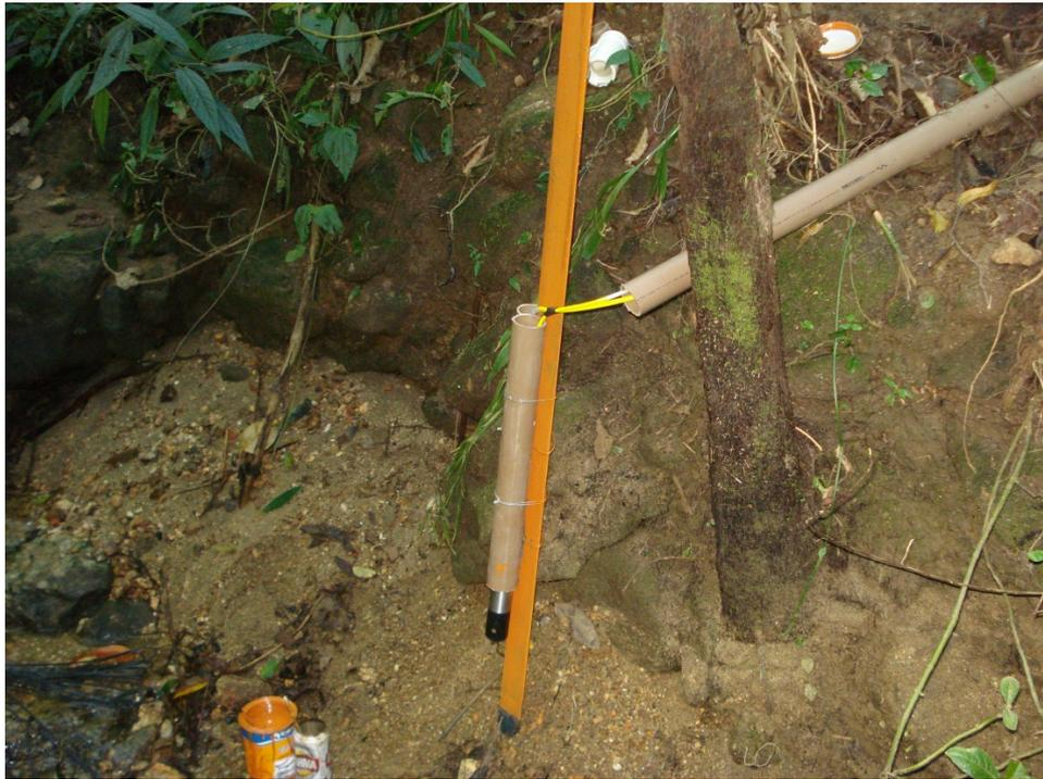
**Figura 4.3.1.2:** Detalhe da instalação dos Sensores de nível d'água e turbidez nas estações fluvio-sedimentométrica.
