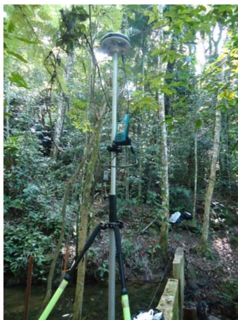
**Figura 4.3.3.2:** Detalhe do Georreferenciamento de precisão das estações Fluvio – Sedimentométricas.
