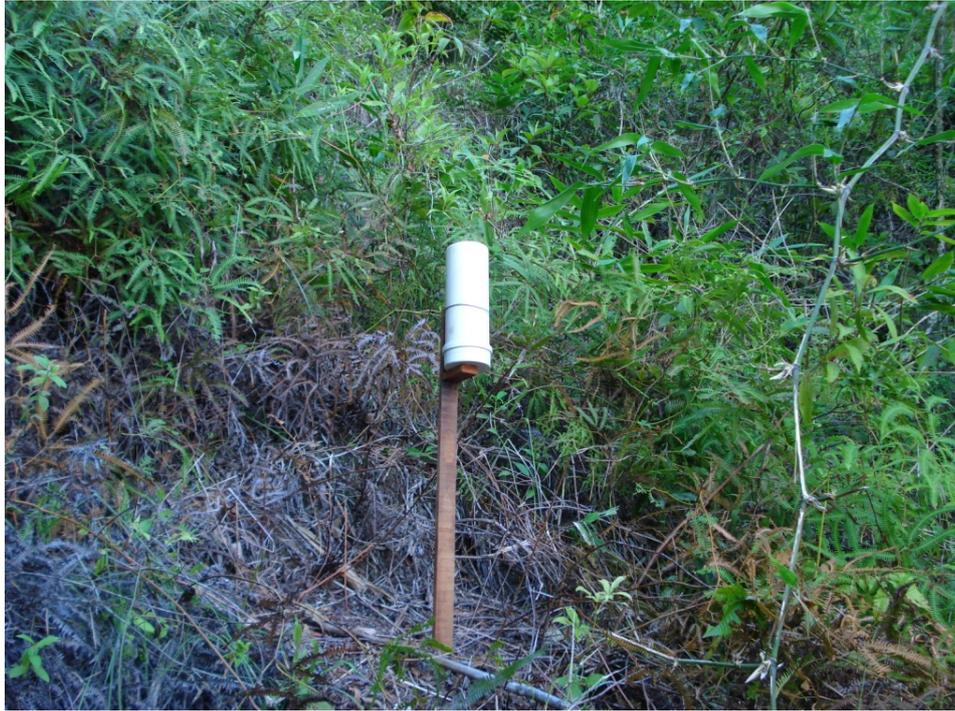
**Figura 4.1.2:** Pluviômetro em área aberta, no interior da cicatriz de deslizamento do Papagaio.
