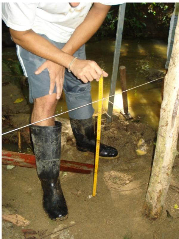
**Figura 4.3.2.1:** Detalhe do levantamento batimétrico de sedimentos depositados por carga de fundo a montante dos vertedouros.
