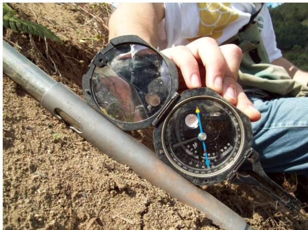
Figura 12 – Bússula de Bruton sendo usada para obtenção da declividade da encosta (Foto: Luana Balbino, 2011).
