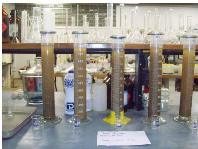
**Figura 20 – Determinação da fração silte a argila através do método da pipetagem (Foto: Luana Balbino, 2011).**
