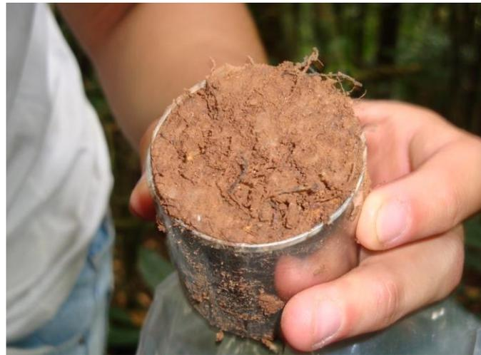
**Figura 17 – Anel volumétrico contendo amostra indeformada de solo (Foto: Luana Balbino, 2011).**
