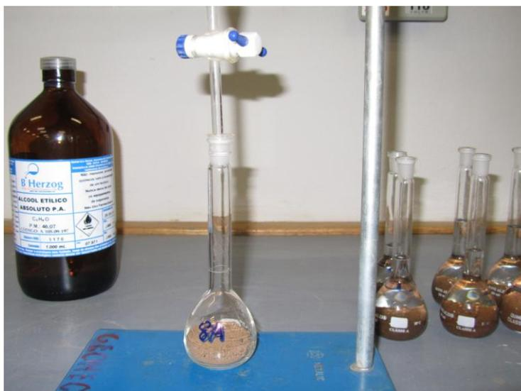
**Figura 21 – Análise de densidade real através do método do balão volumétrico (Foto: Luana Balbino, 2011)**
