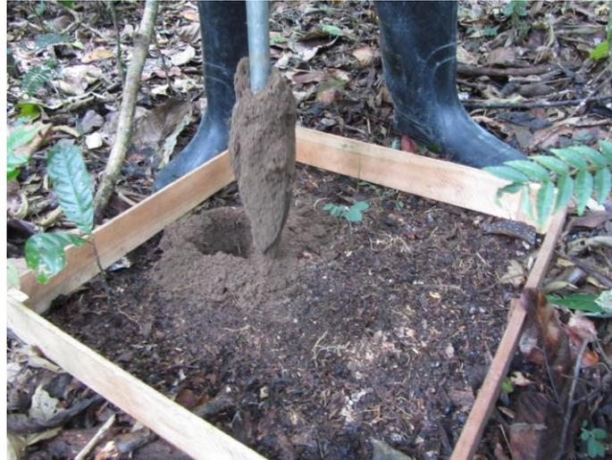
**Figura 16 – Coleta de amostra deformada de solo através de trado mecânico. Amostra sendo retirada do mesmo local onde foi coletada a serrapilheira (Foto: Luana Balbino, 2011).**
