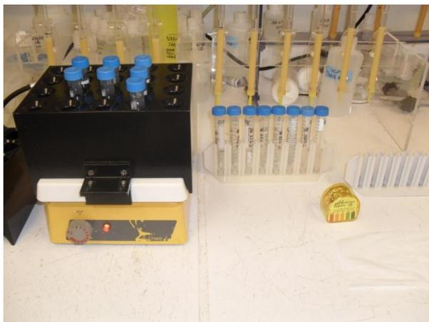
**Figura 96. Precipitação de  $Be(OH)_2$  e  $Al(OH)_3$  nos tubos de ensaio em bloco de aquecimento, após ajuste de pH.**
