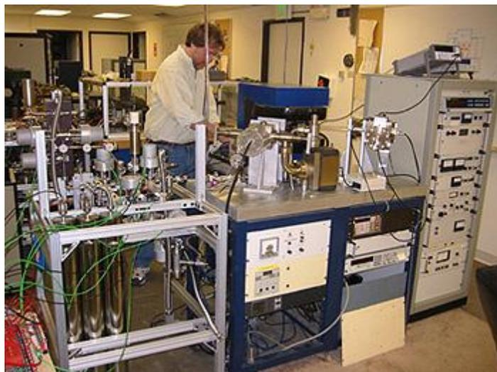
**Figura 99. Espectrômetro de massa de gases nobres ultrasensitivo do laboratório de Termocronometria de Gas Nobre do *Berkeley Geochronology Center*, onde formam mensurados  $^{21}\text{Ne}$  nas amostras de quartzo.**
