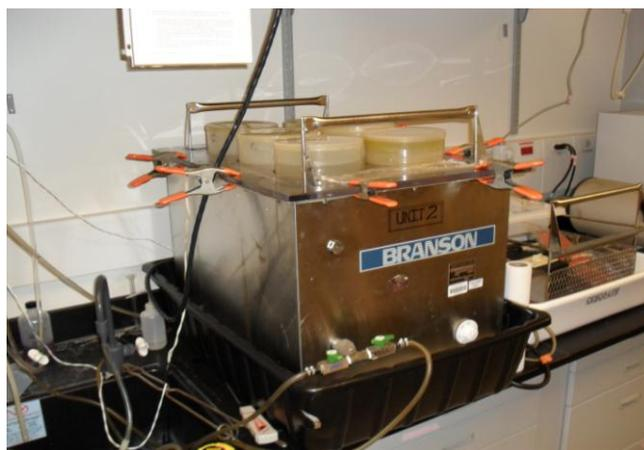
Figura 89. Eliminação de <sup>10</sup>Be atmosférico das amostras (containers de teflon) por sucessivos banhos ultrassônicos a 90 °C com solução de HF-HCl 1%.
