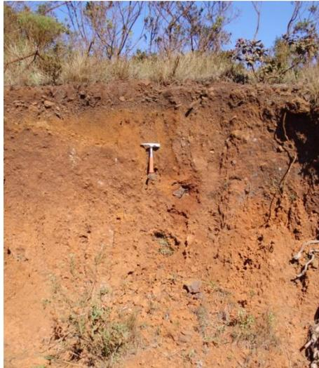
**Figura 753. Perfil de solo sobre itabirito dolomítico de  $\approx$  2,00 m de profundidade, topo da Serra da Água Limpa, QF.**
