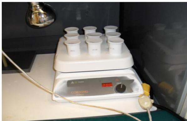
**Figura 92. Dissolução total das amostras de quartzo após adição de  $^9\text{Be}$  em béqueres de Teflon.**
