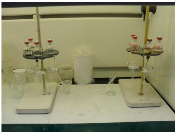
**Figura 94. Separação dos metais Be e Al por decantação em ampolas de vidro via complexação de íons com moléculas de tetracloreto de carbono.**
