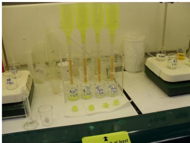
**Figura 93. Separação de íons de Fe e Co das amostras em coluna com resina trocadora de ânions.**
