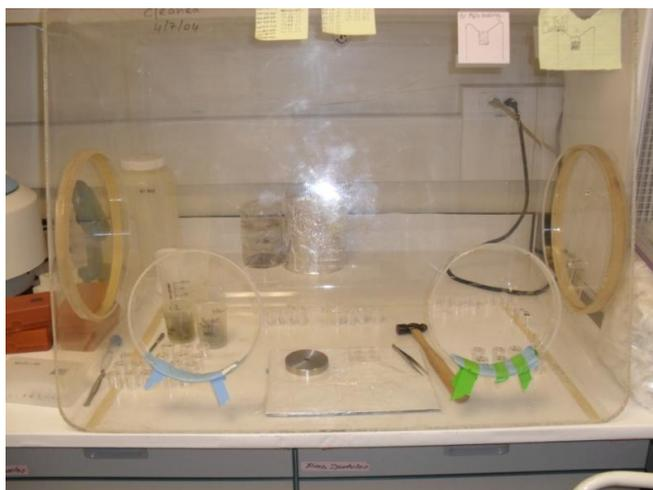
**Figura 98. Cabine onde foi realizada a prensagem óxidos de Be e Al, após serem misturados com Nb e e Ag, respectivamente, em alvos de espectrômetros de massa com aceleração de partículas (AMS).**
