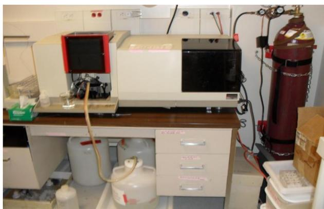
**Figura 91. Aparelho de absorção atômica onde eram mensurados os teores de  $^{27}\text{Al}$  das amostras de quartzo.**
