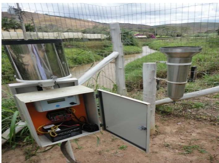
Figura 5.12: Pluviômetros automático (lado esquerdo) e o manual (lado direito) situados na bacia de estudo.
