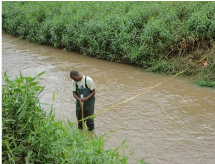
Figura 5.10: Medição de vazão com molinete hidrométrico na estação baixo curso
