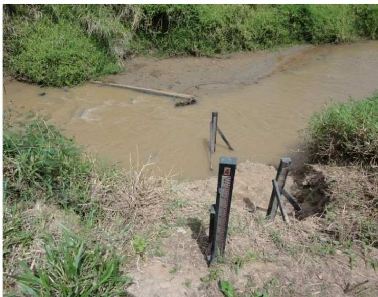
Figura 5.9: Régua linimétrica instalada na margem do canal fluvial, situada no baixo curso da bacia do Córrego Sujo.
