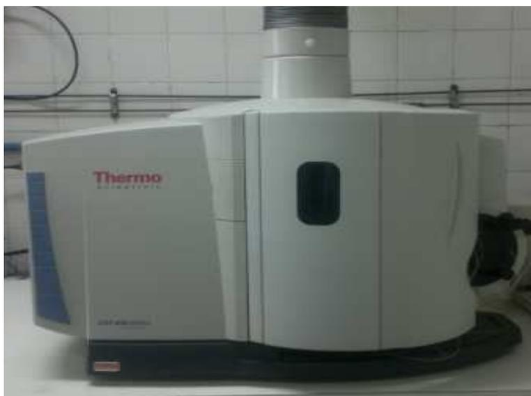
Figura 5.8: Espectrômetro de emissão óptica com fonte de plasma indutivamente acoplado (ICP - OES), LaDa - UFRJ.
