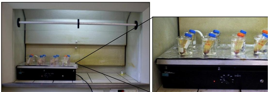
Figura 19: Lixiviação do sedimento, colocado em banho-maria por 24h.
