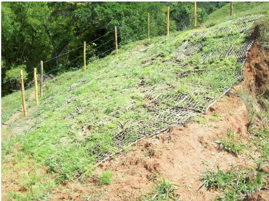
FIGURA 102. Visão lateral e próxima da área-teste de geotêxteis de bananeira, em 30 de março (Hugo Alves S. Loureiro, 2012).
