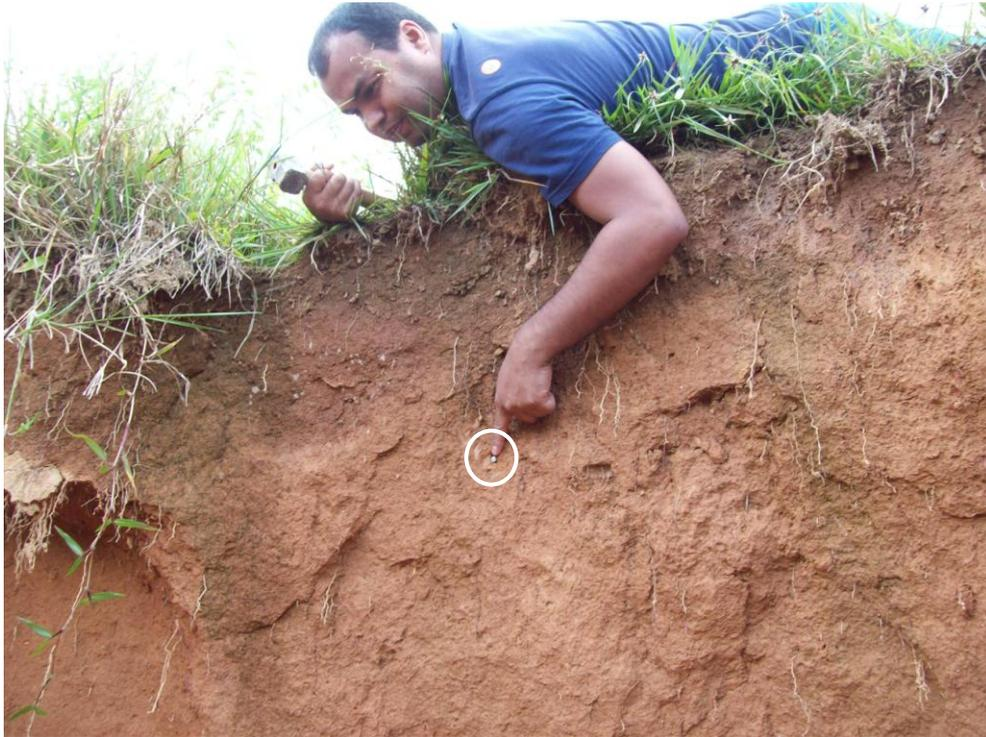
FIGURA 20. Instalação do 1º pino de erosão da 2ª coluna de pinos da cabeceira esquerda (CE 2.1), a 0,5m do topo do solo (Hugo Alves S. Loureiro, 2011).
