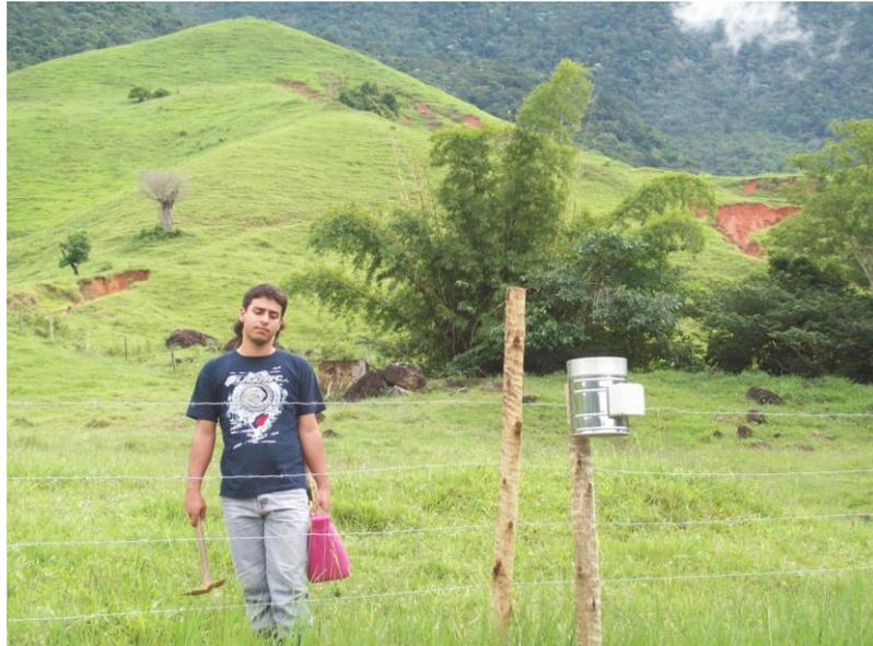
FIGURA 43. Pluviógrafo instalado em parcela de erosão de solos na mesma fazenda da área monitorada não registrou a pluviosidade para todo o período da pesquisa (Hugo Alves S. Loureiro, 2011).
