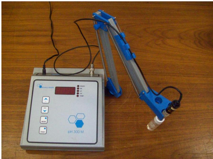
FIGURA 36. Medidor de pH Analyser modelo pH 300 M (Hugo Alves S. Loureiro, 2011).
