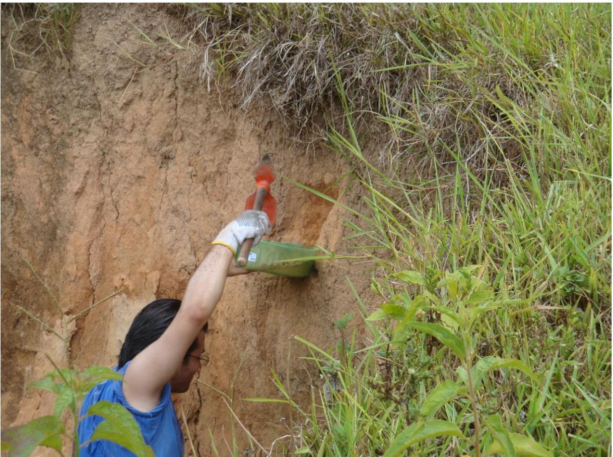
FIGURA 29. Coleta de amostra deformada no intervalo 0-0,5 m de profundidade pelo lado direito da cabeceira da voçoroca (Sara Regina de A. Neves, 2011).
