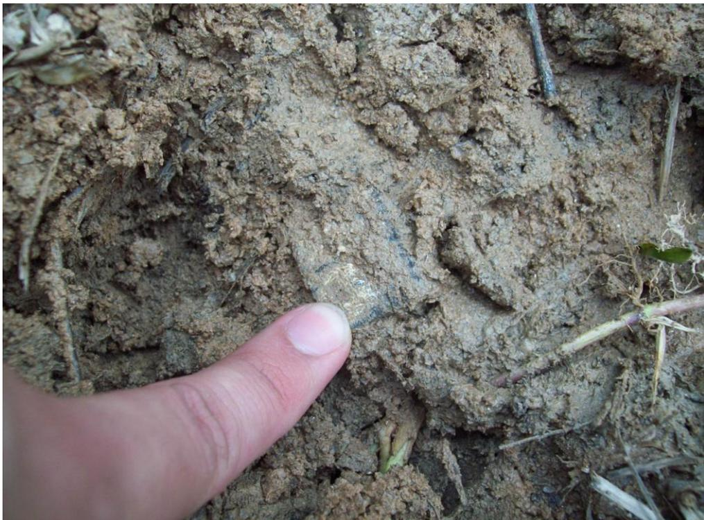
FIGURA 48. Estaca 9B totalmente enterrada devido à passagem/pisoteio do gabo sobre ela, em novembro de 2011 (Hugo Alves S. Loureiro, 2011).
