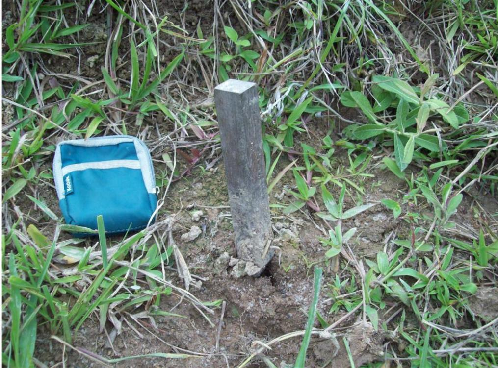
FIGURA 47. Estaca 6A desenterrada pela erosão laminar, curiosamente de pé, antes de ser monitorada, em novembro de 2011 (Hugo Alves S. Loureiro, 2011).
