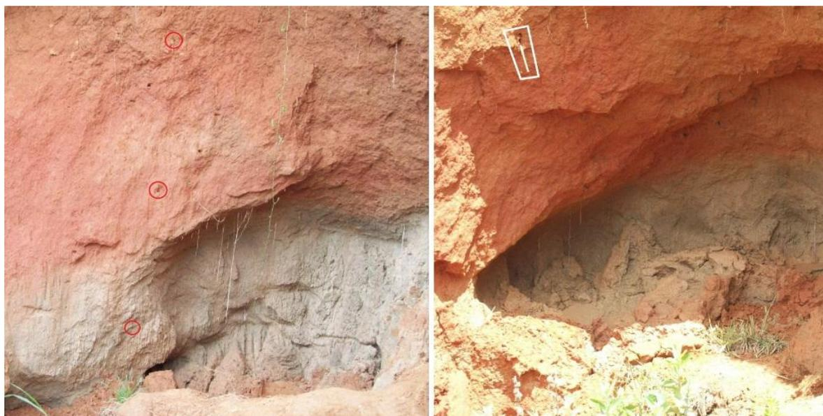
FIGURA 62. Comparação da 3ª coluna da CE da voçoroca: (a) em maio de 2011 (Hugo Alves S. Loureiro, 2011); (b) no monitoramento de janeiro de 2012, destacando-se (em branco) o pino CE 3.1 torto ou pendurado após solapamento do solo, e a remoção do pino CE 3.2 (Hugo Alves S. Loureiro, 2012).
