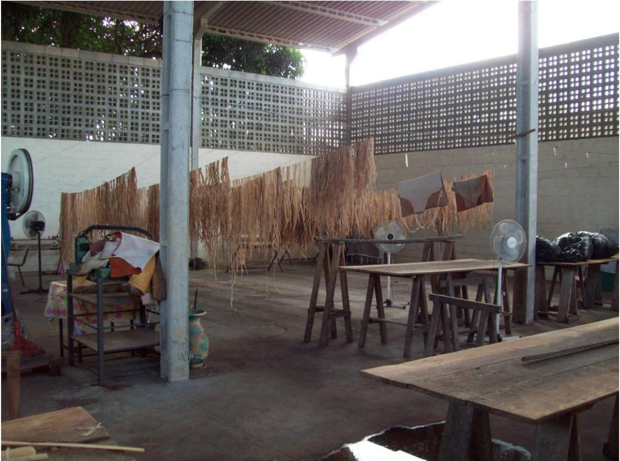
FIGURA 27. Varal para secagem das fibras já separadas no galpão de preparo e confecção (Hugo Alves S. Loureiro, 2011).
