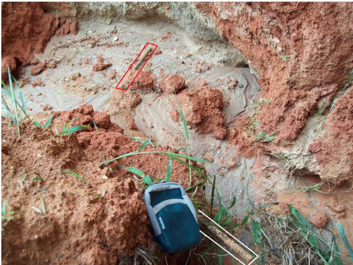
FIGURA 70. Pinos CE 2.2 (destacado de branco) e CE 3.2 (destacado de vermelho) removidos junto ao solapamento do solo; registro de abril de 2012 ( Hugo Alves S. Loureiro, 2012).
