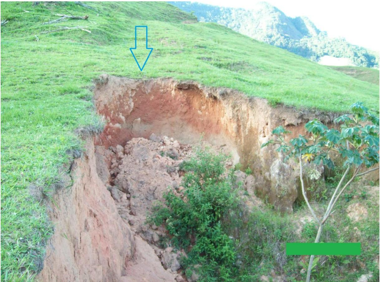
FIGURA 85. Voçoroca em dezembro de 2012. Desde a última ida a campo (maio de 2012), a cabeceira recuou notadamente. O solo da parede solapou e soterrou toda a alcova de regressão, modificando bastante o visual que se habituou a ter da cabeceira, durante mais de dois anos de visitas ao local (Hugo Alves S. Loureiro, 2012).
