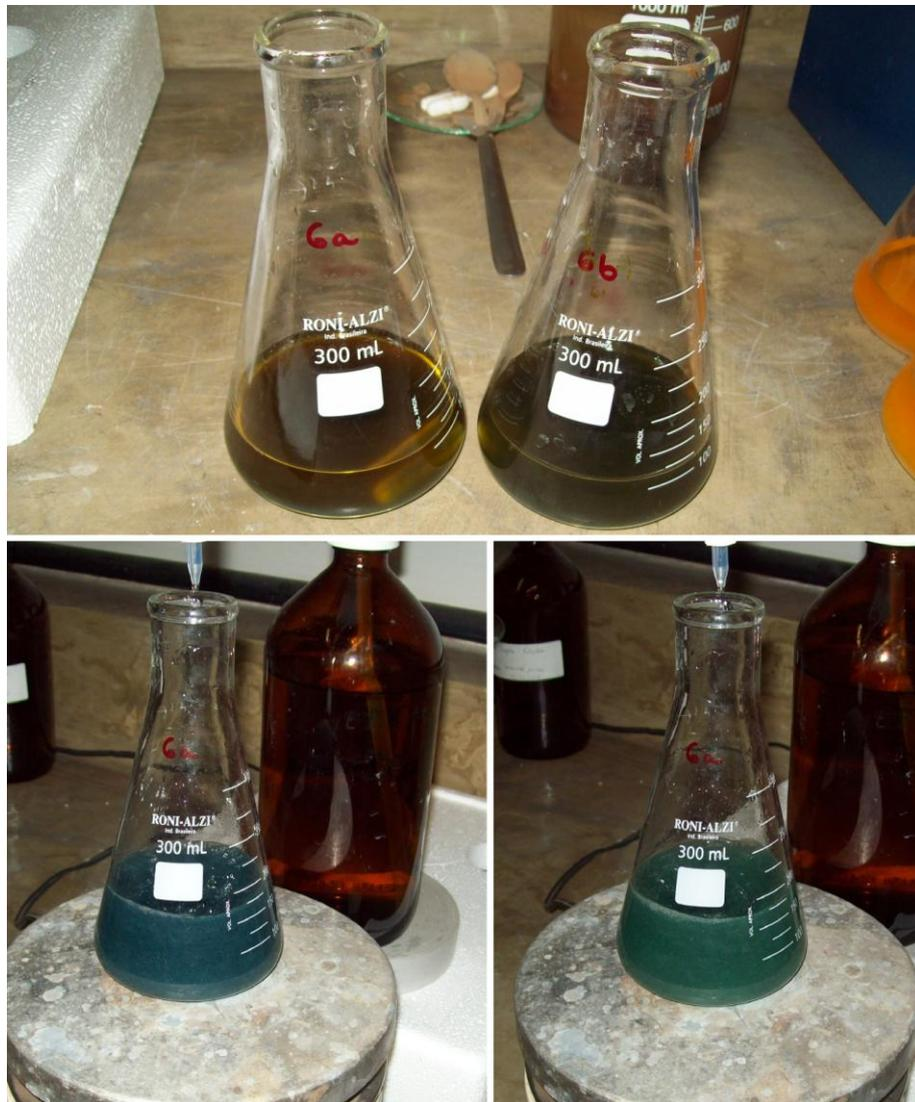
FIGURA 35. (a) Erlenmeyers com 0,5g da amostra CE 2,5-3,0m com ácido ortofosfórico e gotas de difenilamina adicionados, prontos para titulação; (b) durante a titulação com sulfato ferroso amoniacal apresentando cor azulada; (c) momento em que muda a coloração para verde, encerrando a titulação, anotando-se o volume gasto de solução (Hugo Alves S. Loureiro, 2012).
