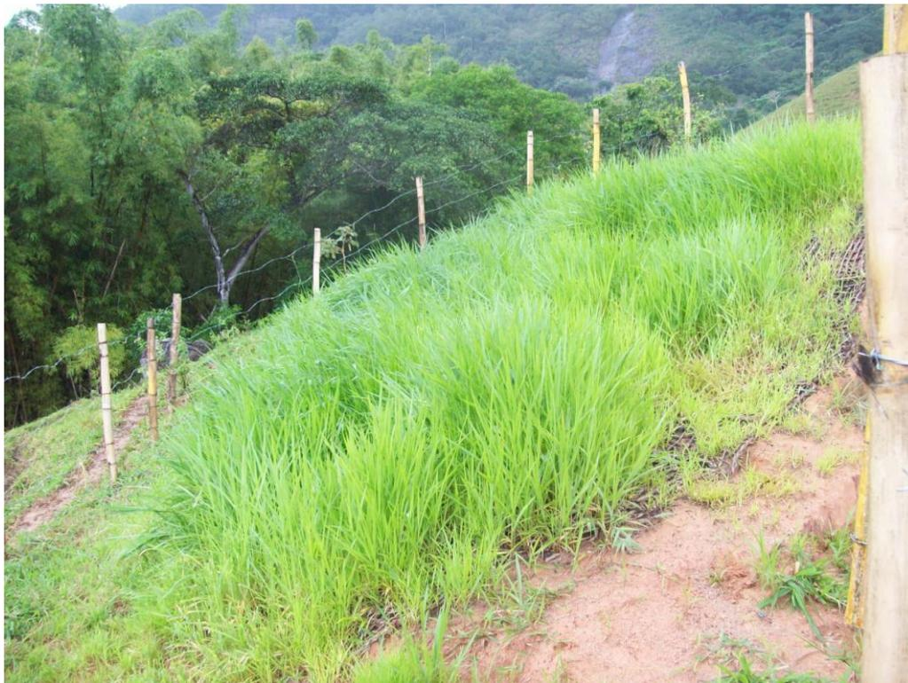
FIGURA 103. Visão lateral e próxima da área-teste de geotêxteis de bananeira, em 21 de maio (Hugo Alves S. Loureiro, 2012).
