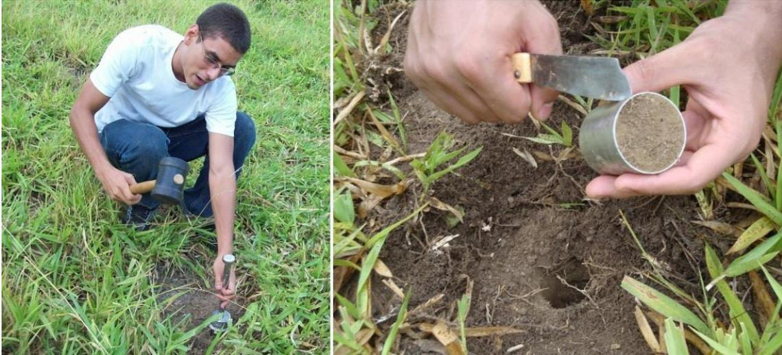
FIGURA 32. Coleta de amostras indeformadas com amostrador volumétrico (de 100 cm<sup>3</sup>), na bacia do rio São Pedro (Hugo Alves S. Loureiro, 2011; Sara Regina de A. Neves, 2011).
