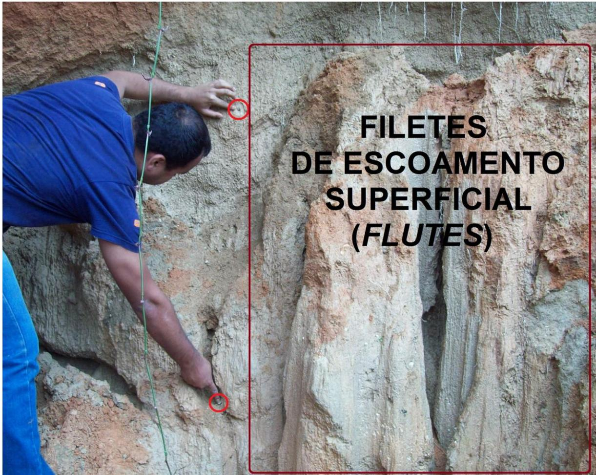
FIGURA 52. Área dos pinos CE 2.3 e 2.4 apresentando filetes subverticais de escoamento superficial (*flutes*) na alcova de regressão, em maio de 2011, mês de instalação dos pinos de erosão (Hugo Alves S. Loureiro, 2011).
