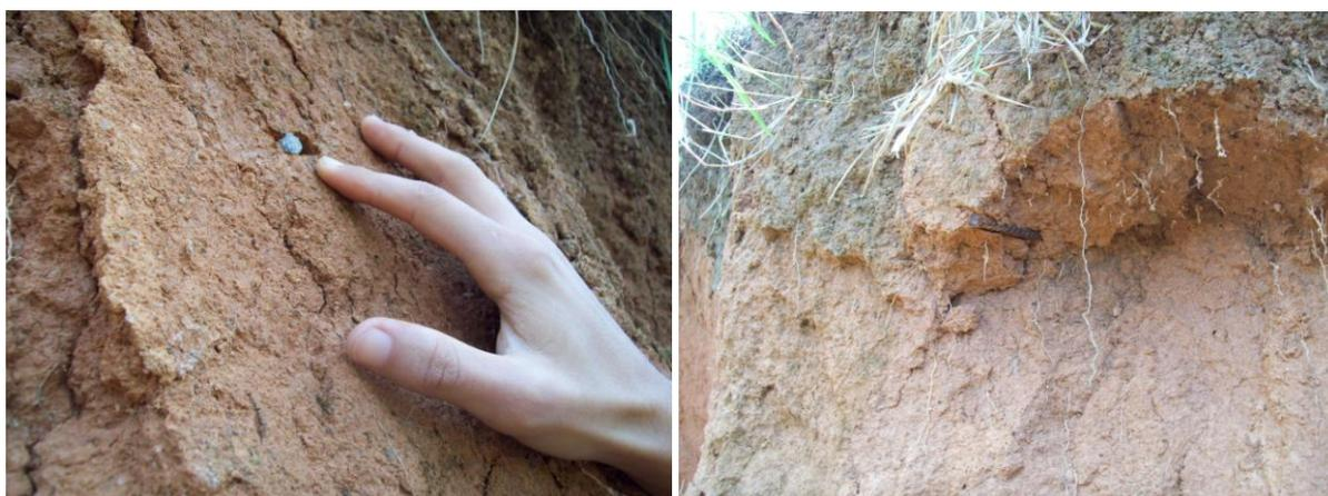
FIGURA 60. (a) Pino CD 1.1 na instalação dos pinos na voçoroca, em maio de 2011 (Hugo Alves S. Loureiro, 2011); (b) e no monitoramento de janeiro de 2012, registrando seu primeiro solapamento (Hugo Alves S. Loureiro, 2012).
