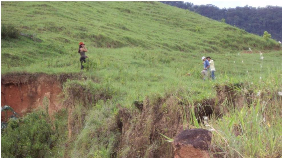
FIGURA 16. Colocação das estacas 6A e 6B e medição com trena de 50 metros (Maria do Carmo O. Jorge, 2011).
