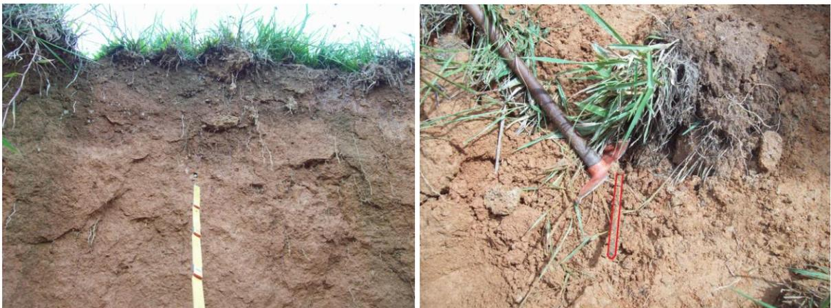
FIGURA 61. (a) Pino CE 2.1 na instalação dos pinos na voçoroca, em maio de 2011 (ponto prateado acima do metro de madeira) (Hugo Alves S. Loureiro, 2011); (b) e no monitoramento de janeiro de 2012 (em vermelho), soterrado pelo solapamento do solo a sua volta (Hugo Alves S. Loureiro, 2012).
