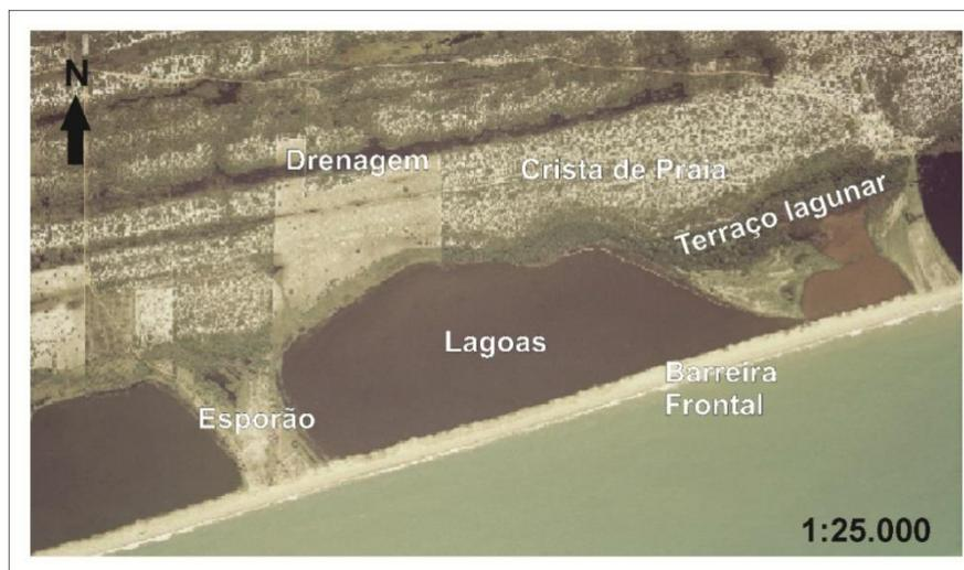
Figura 40: Identificação das principais classes de mapeamento geomorfológico na escala 1:25.000, sob ortofotos
