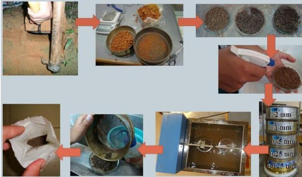
**Figura 12:** Processo de coleta e análise das amostras para determinação da estabilidade de agregados em água. Acervo: L. A. Rangel, 2012.
