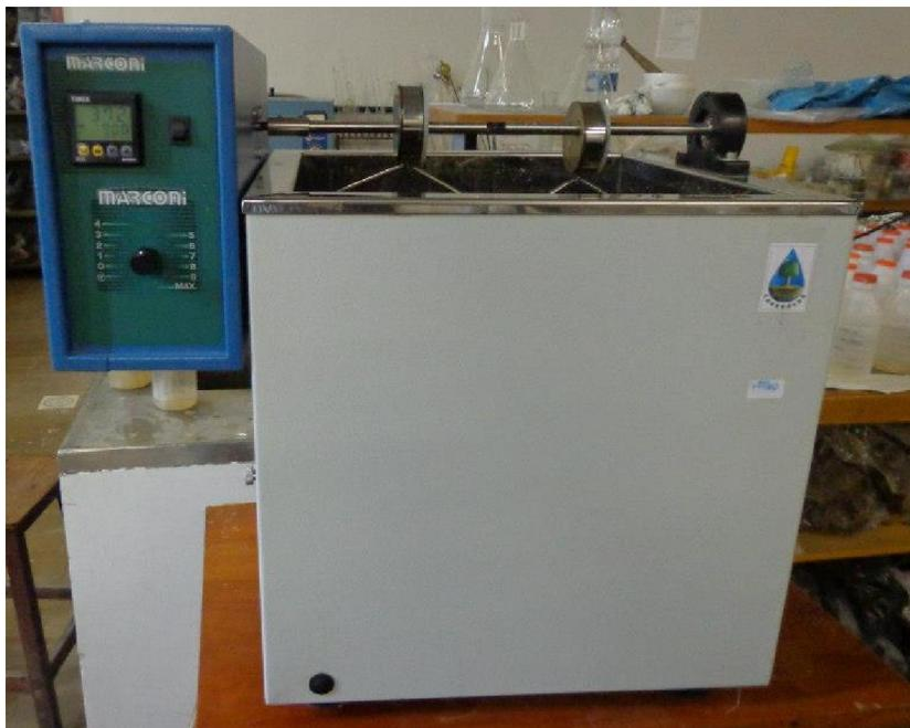
**Figura 11:** Aparelho de Yoder onde as amostras são submetidas ao tamisamento úmido. Acervo: L. A. Rangel, 2012.
