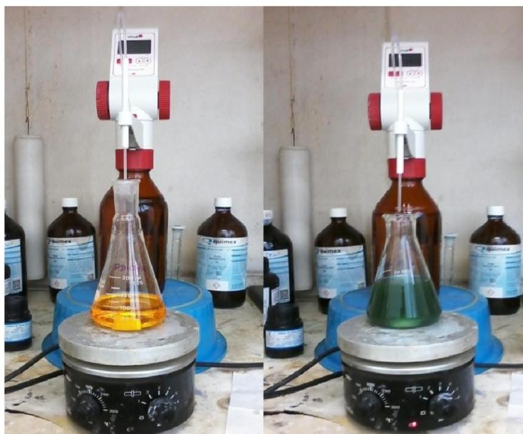
**Figura 15:** Erlenmeyers com 0,5g da amostra com dicromato de potássio e ácido ortofosfórico adicionados (esquerda); término da titulação, após a mudança da coloração da solução para verde, encerrando a titulação (direita). Acervo: L. A. Rangel, 2013.
