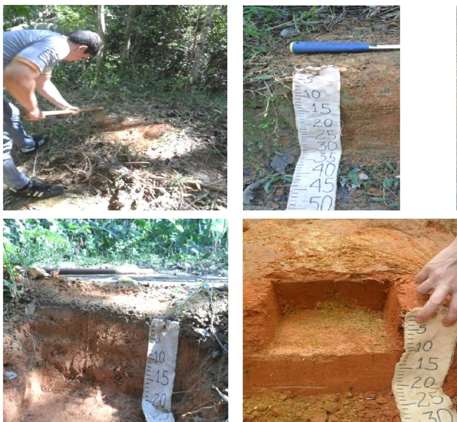
**Figura 10:** Abertura de trincheira para coleta de blocos para realização da estabilidade de agregados. Acervo: L. A. Rangel, 2012.
