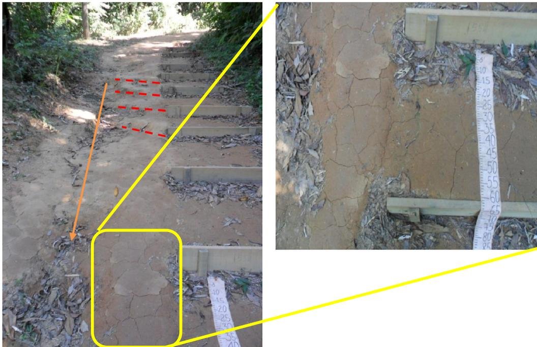
**Figura 35:** Terceiro ponto de coleta onde foram colocados degraus de madeira e em seu prolongamento existe a formação de degraus sem contenção (em vermelho), ao lado dos degraus verifica-se o início de uma feição erosiva (seta em laranja) e observa-se, ainda, o solo com “fissuras” indicando a grande compactação do mesmo (detalhe em amarelo). L. A. Rangel, 2012.
