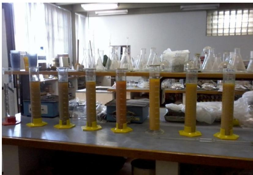
**Figura 13:** Pipetagem da fração argila durante a análise granulométrica. Acervo: L. A. Rangel, 2012.
