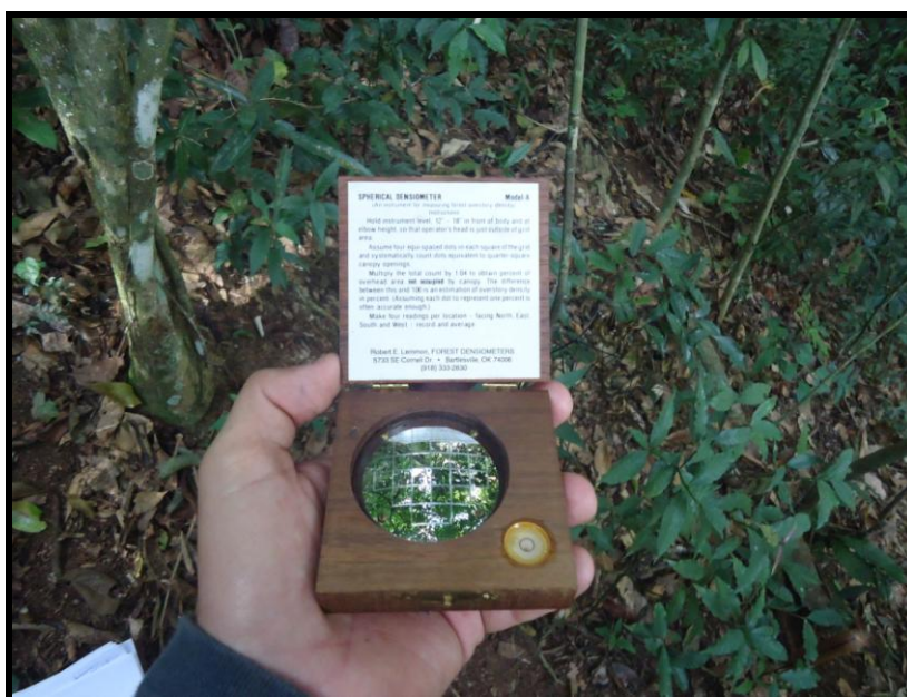
Figura 20: Densiômetro Esférico Convexo utilizado para a obtenção do percentual de cobertura do dossel (Acervo NESAG - IGEO/UFRJ).
