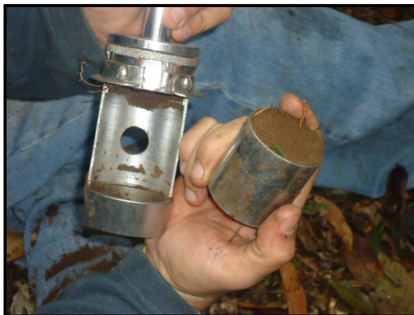
Figura 23: Coleta de solo com utilização de anéis de Koppec (Acervo NESAG - IGEO/UFRJ).
