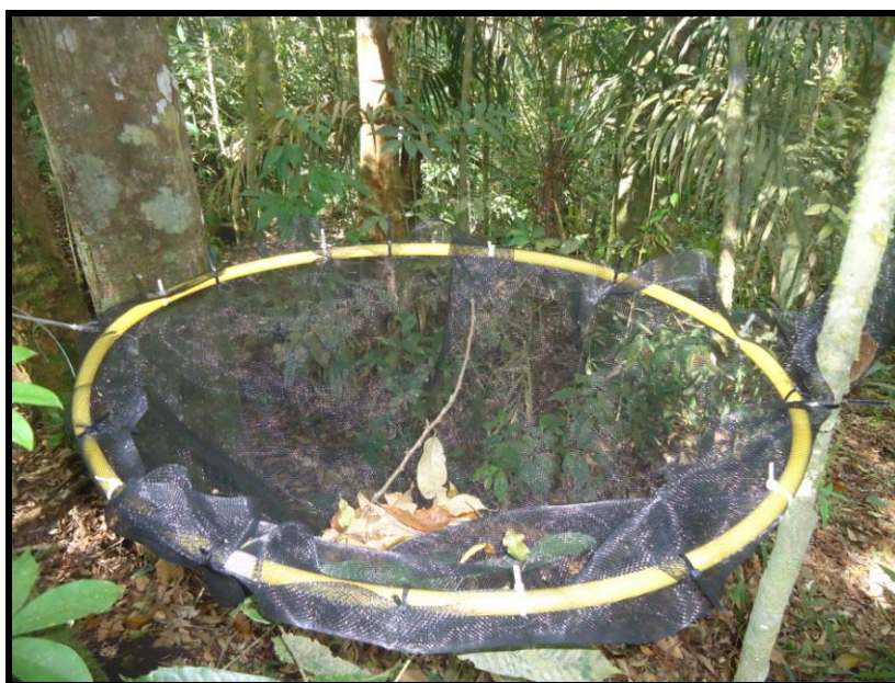
Figura 21: Coletor de serapilheira instalado nas parcelas (Acervo NESAG - IGEO/UFRJ).
