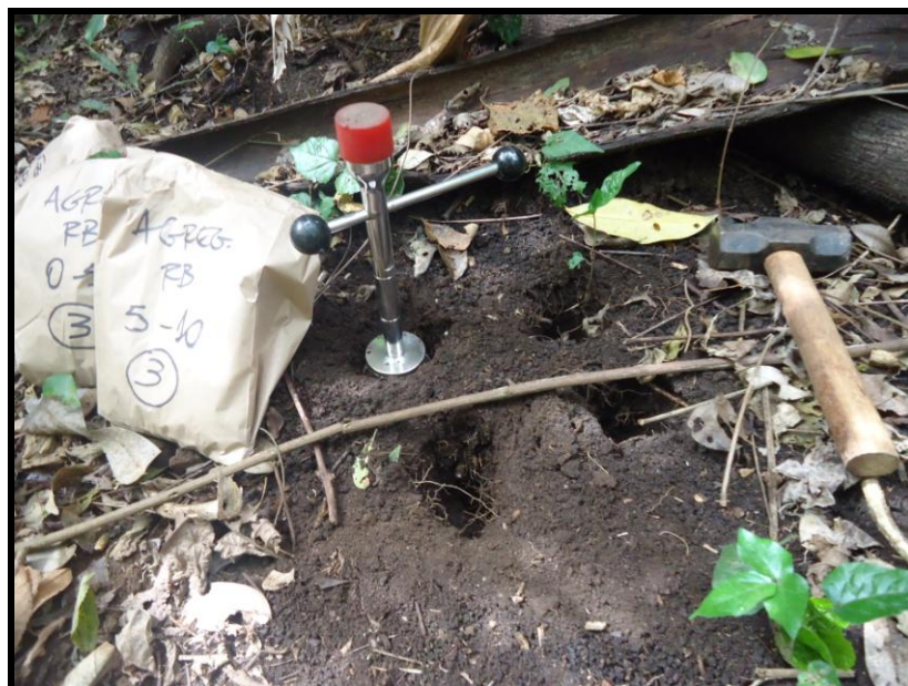
Figura 24: Coletas de solo realizadas após a retirada do estoque de serapilheira (Acervo NESAG - IGEO/UFRJ).
