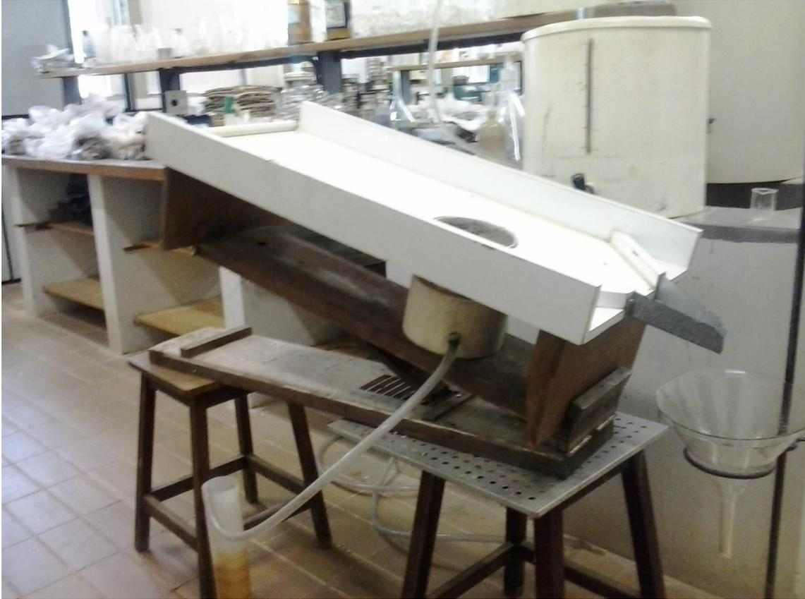
Figura 22. Rampa para o ensaio de Inderbitzen
