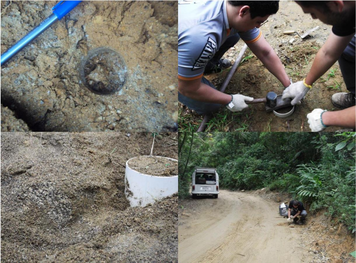
Figura 19. Buraco após retirada da amostra volumétrica (superior esquerda); coleta de amostra para Inderbitzen (superior direita); amostrador de Inderbitzen fincado no solo (inferior esquerda); aspecto do ponto coletado (inferior direita)
