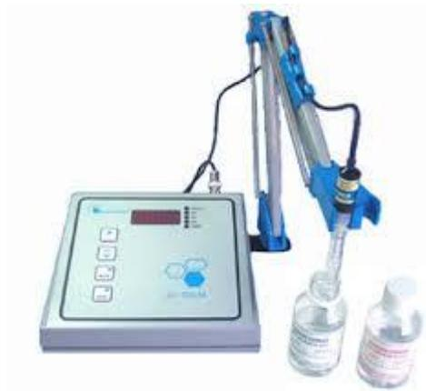
Figura 20. Phmetro utilizado nas análises de pH
