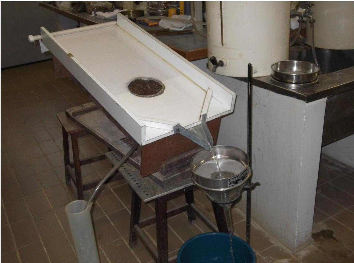
Figura 23. Ensaio de Inderbitzen sendo realizado
