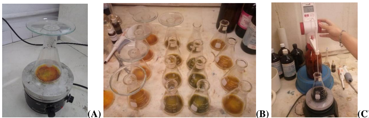
Figura 19: Etapas das análises de matéria orgânica. Aquecendo a solução em placa elétrica (A); soluções em repouso (B); processo de titulação (C). Foto: Leonardo S. Pereira (2013).
