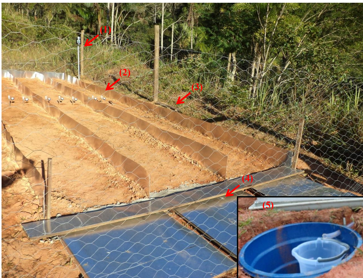
Figura 24: Visão geral da estação experimental de erosão de solos, salientando o pluviógrafo (1); os tensiômetros (2); as parcelas de erosão (3); as caixas coletoras de sedimento (4 e 5). Foto: Leonardo S. Pereira (2013).
