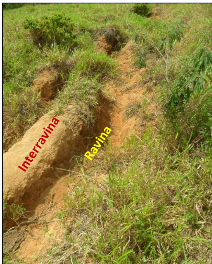
Figura 32. Trecho da degradação observada no P5. Em destaque a configuração da ravina ali desenvolvida (Foto: Sara Neves, 2014).
