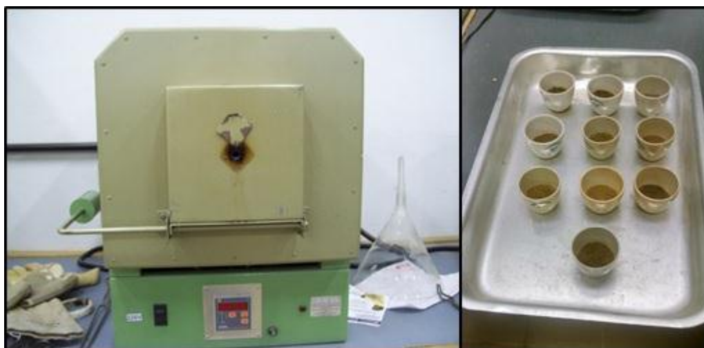
Figura 12. Forno mufla e cadinhos com amostras, ambos usados para a análise de matéria orgânica pelo método direto (Sara Neves, 2015).
