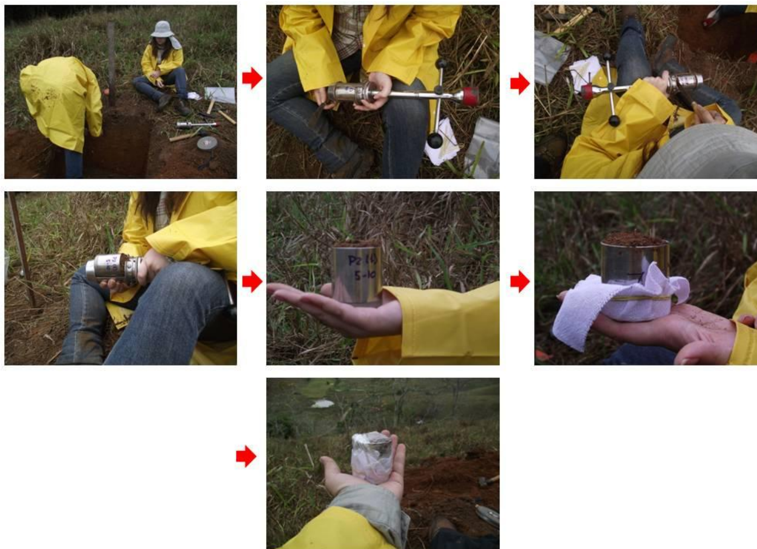
Figura 13 – Metodologia de amostragem, utilizando anéis de Kopecky ( 104,01 \text{ cm}^3 ) e amostrador indeformado da SondaTerra.
