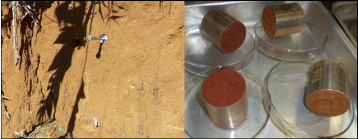
Figura 13. Utilização de anéis de Kopeck de 100 cm 3 para a retirada de amostras volumétricas. Fotos: Aline M. Rodrigues (2015).
