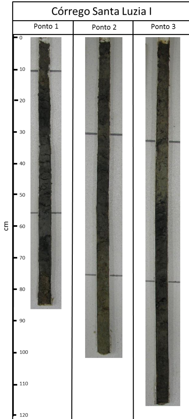
Figura 6.3: Testemunhos obtidos do canal embrejado da sub-bacia Córrego de Santa Luzia I, Volta Redonda (RJ).
