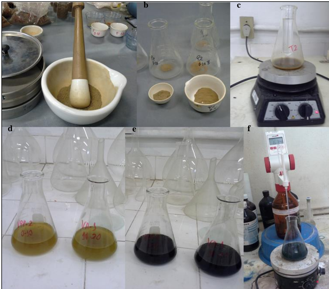
Figura 11: Análise de matéria orgânica: trituração do solo em gral (a), amostras de solo triturado e peneirado são pesadas em Erlenmeyer (b), aquecimento da solução em placa elétrica (c), solução antes do aquecimento (d), solução com indicador (e) e titulação (f). Fotos: Rafael C. Santos, 2016.
