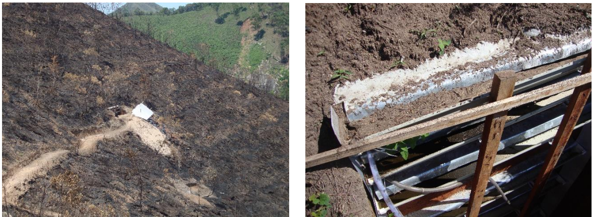
Figura 45 a) Área de gramínea após incêndio. b) Acúmulo de sedimentos carreados na primeira calha da Trincheira 2.
