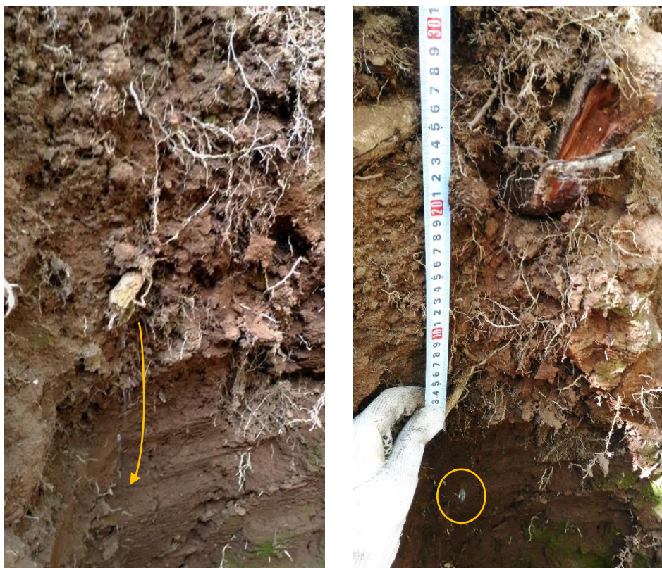
Figura 58 Gotejamento a partir de uma raiz grossa localizada na parede lateral esquerda da Trincheira 1.
