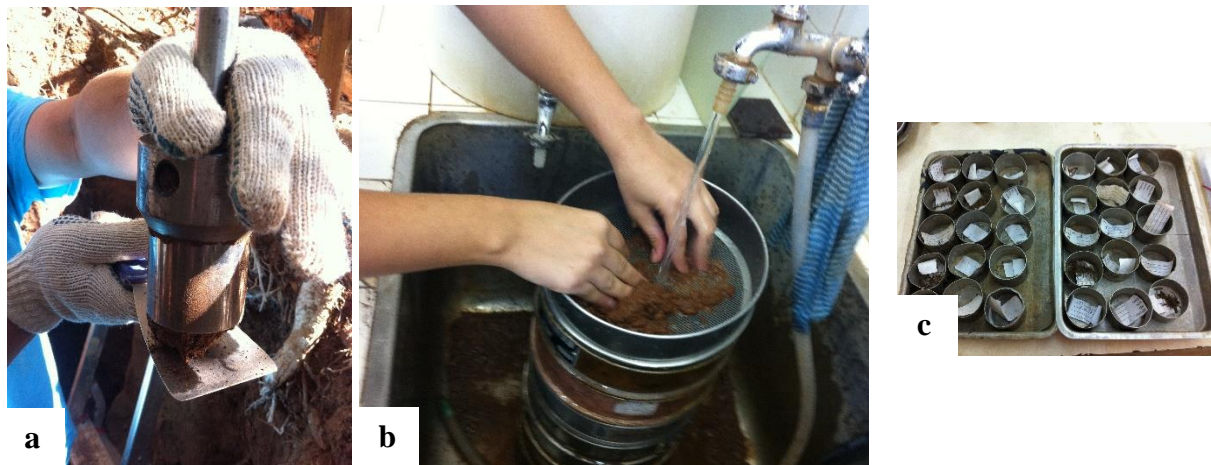
Figura 14 a) Retirada de amostra com anel de kopeck e amostrador. b) Lavagem da amostra no conjunto de peneiras para posterior separação das raízes finas. c) Raízes finas separadas por profundidade e etiquetadas antes de serem levadas à estufa.
