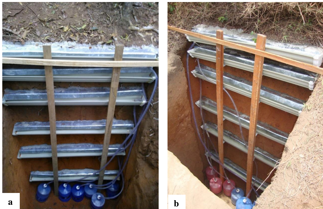
Figura 16 Trincheiras com calhas coletoras de fluxo subsuperficial. a) Trincheira 1. b) Trincheira 2.
