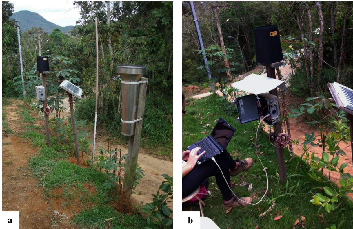
Figura 10 a) Pluviômetro automático a esquerda e pluviômetro manual a direita. b) Dados de precipitação sendo baixados do pluviômetro automático.
