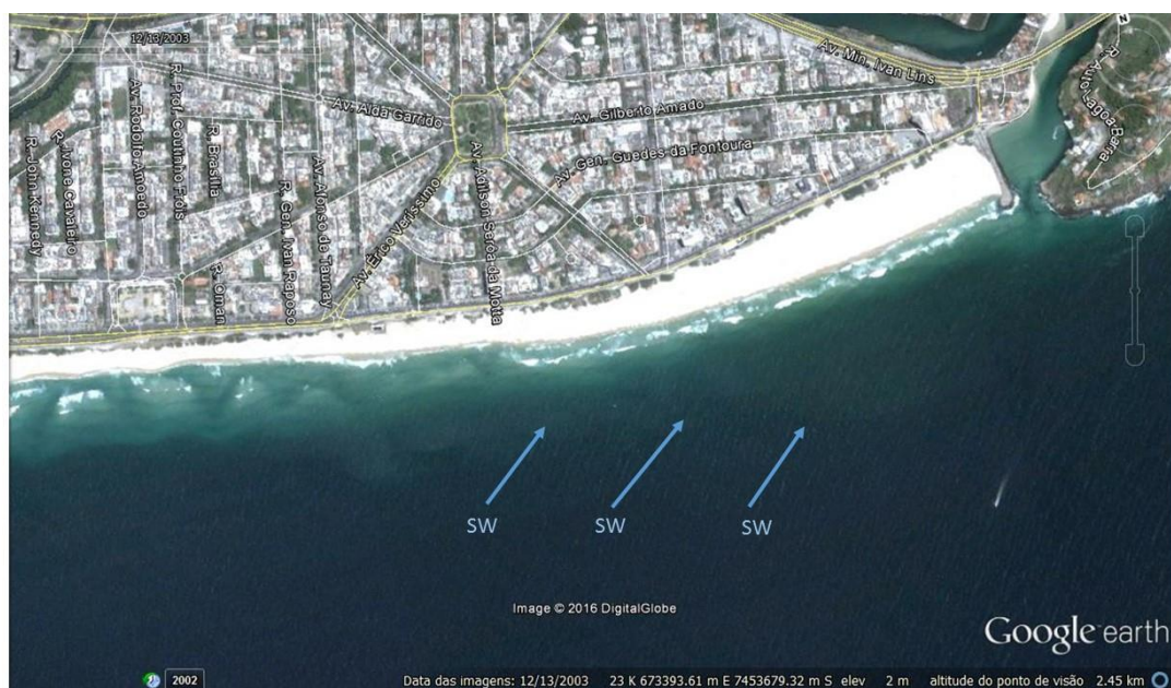
Figura 10- Erosão na parte central da Praia da Barra e acúmulo no quebra-mar, em posição perpendicular ao ângulo das ondas - Fonte: Google Earth.
