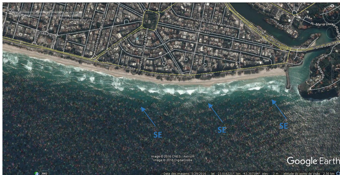
Figura 11- Transporte de sedimentos por ondas de sudeste. - Fonte: Google Earth.
