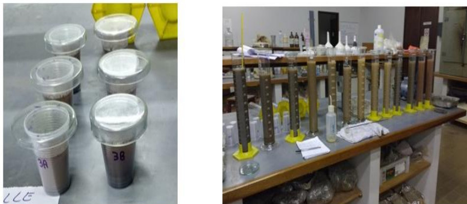
FIGURA 19: ETAPAS PARA ENSAIO DE GRANULOMETRIA. FONTE: ACERVO PESSOAL.
