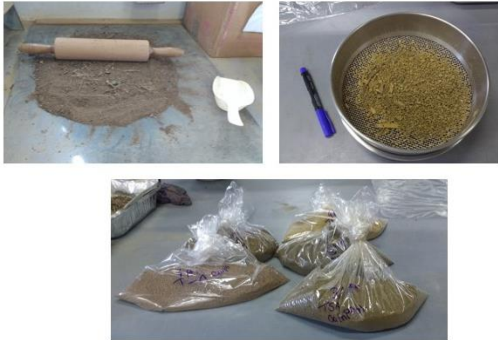
FIGURA 18: PROCEDIMENTOS METODOLÓGICOS PARA ENSAIO DE GRANULOMETRIA. FONTE: ACERVO PESSOAL.
