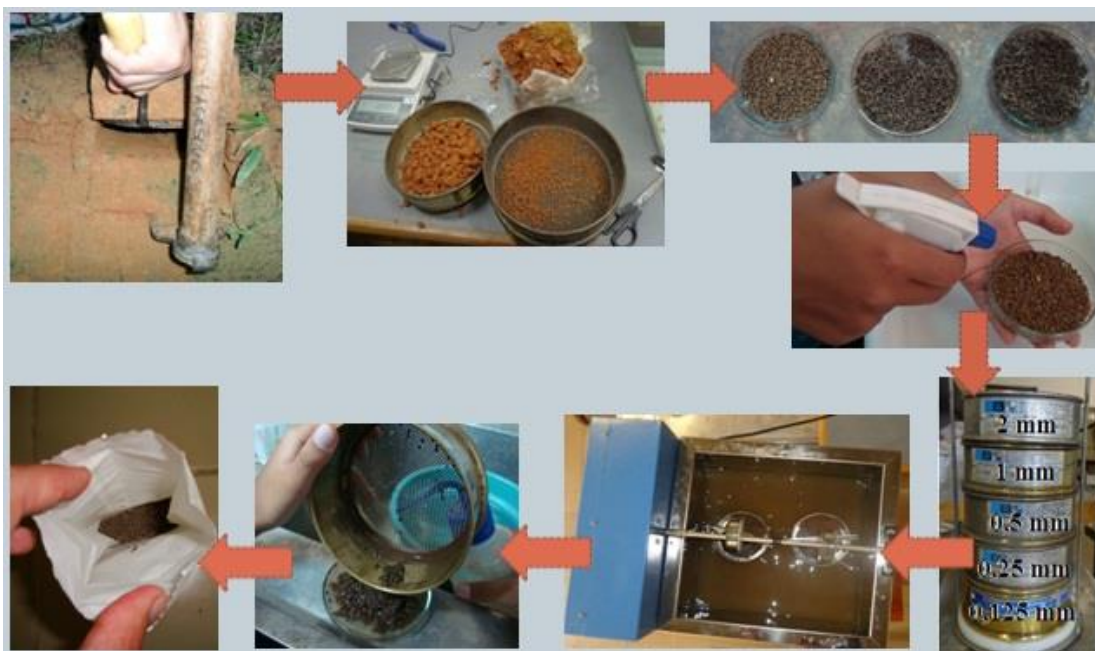
Figura 16. Processo de coleta e análise das amostras para determinação da estabilidade de agregados em água. Fonte: Rangel (2014).
