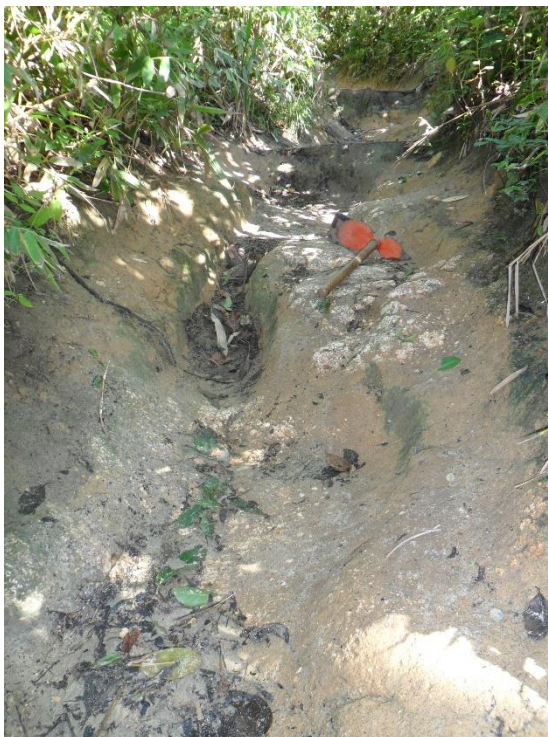
Figura 19. Primeiro ponto de coleta na trilha PMC, com ravina no leito da trilha e exposição de horizonte C.
