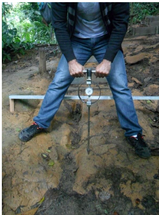
Figura 14. Medição da capacidade de penetração no leito da trilha PNC através da utilização do penetrômetro. Foto: L. A. Rangel (2016).
