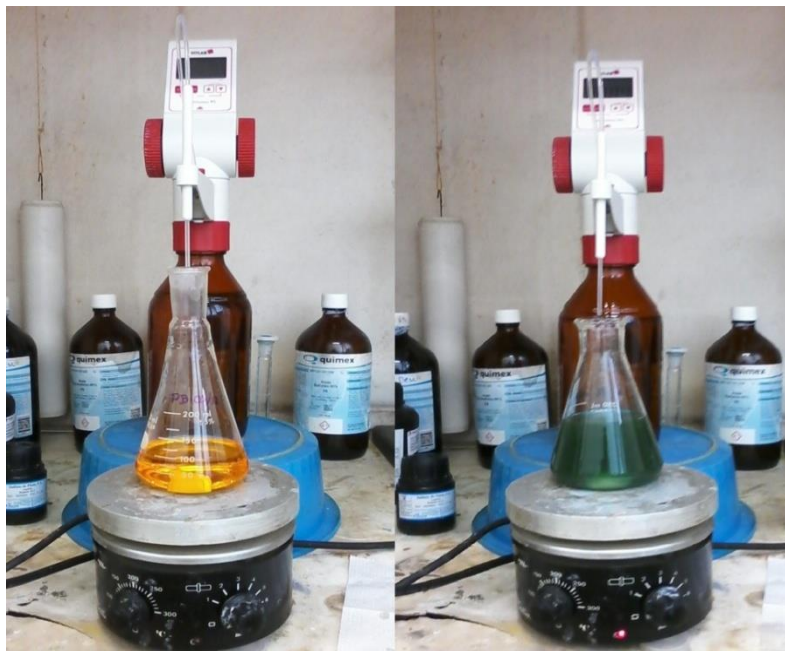
Figura 17. Erlenmeyers antes da titulação (esquerda); e após a mudança da coloração da solução para verde, encerrando a titulação. Fonte: Rangel (2014)
