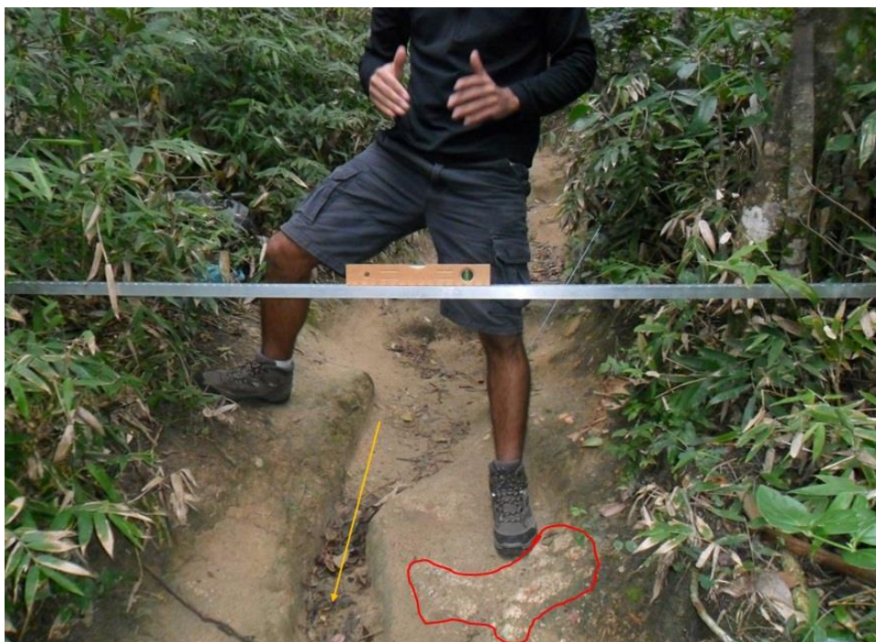
Figura 21. Análise da microtopografia do solo, através da ponte de erosão, em PE 1 da trilha PMC em junho de 2016. A seta em amarelo indica ravina com acúmulo de serapilheira e o destaque em vermelho indica início de exposição do horizonte C. Foto: L. A. Rangel (2016).
