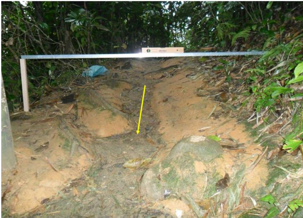
Figura 26. Análise da microtopografia do solo em PE 3 na trilha PNC. Ravina com acúmulo de serapilheira (seta amarela), raízes expostas e blocos rochosos no leito. Foto: L. A. Rangel (2016).
