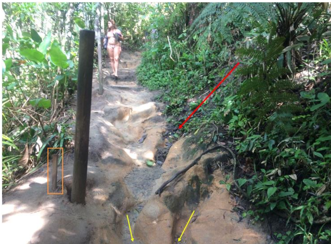
Figura 23. Microtopografia do solo em PE 2 da trilha PMC em janeiro de 2017, com pequeno deslizamento no TS e deposição de serapilheira no leito (seta em vermelho), ravinas monitoradas (setas em amarelo) e estaca de nivelamento ainda presente (destaque em laranja). Foto: L. A. Rangel (2017).
