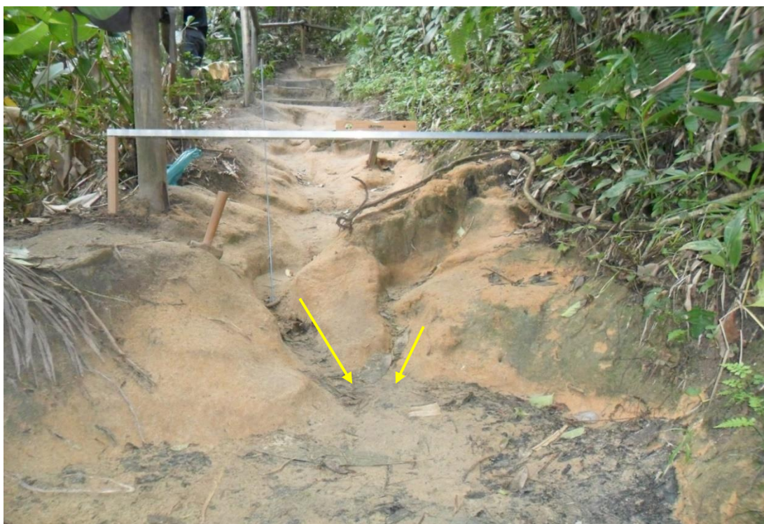
Figura 22. Microtopografia do solo em PE 2 da trilha PMC em outubro de 2016, com vegetação presente no talude superior e ravinas no leito (setas amarelas). Foto: L. A. Rangel (2016).
