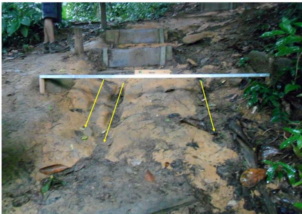
Figura 27. Análise da microtopografia do solo em PE 4 na trilha PNC. Ravinas no leito da trilha com acúmulo de serapilheira (setas amarelas). Foto: L. A. Rangel (2016).
