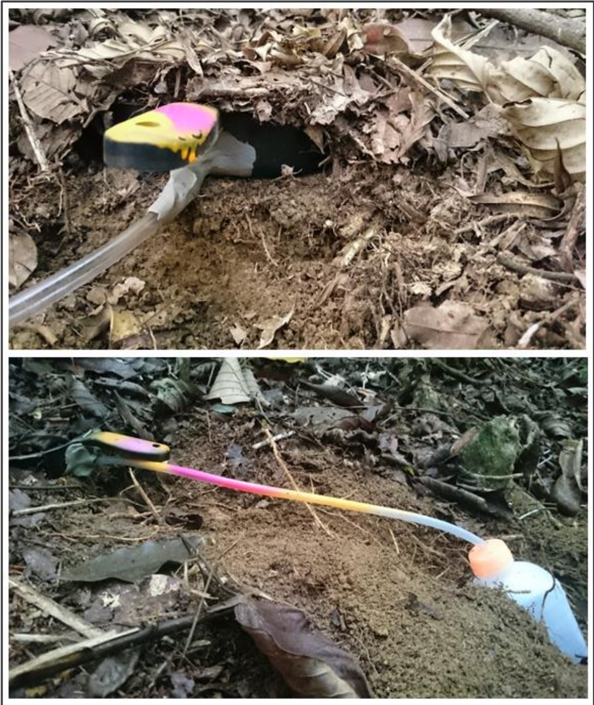
Figura 21: Coletores do fluxo atravessado pela serrapilheira ( P_s ) instalado em campo, conectados ao recipientes de armazenamento.
