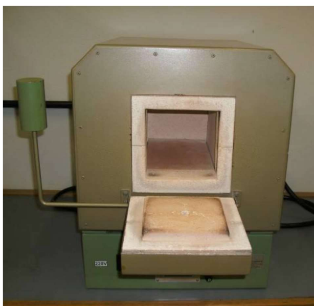
Figura 33: Equipamento forno mufla utilizado para a queima da Matéria Orgânica a 500°C. Foto: Fábio Lima, 2010.
