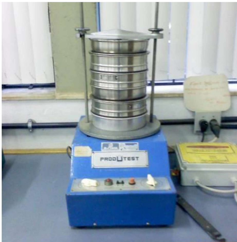
Figura 29: Análise da granulometria por peneiramento segundo o método da EMBRAPA (1997). Foto: Fábio Lima, 2010.
