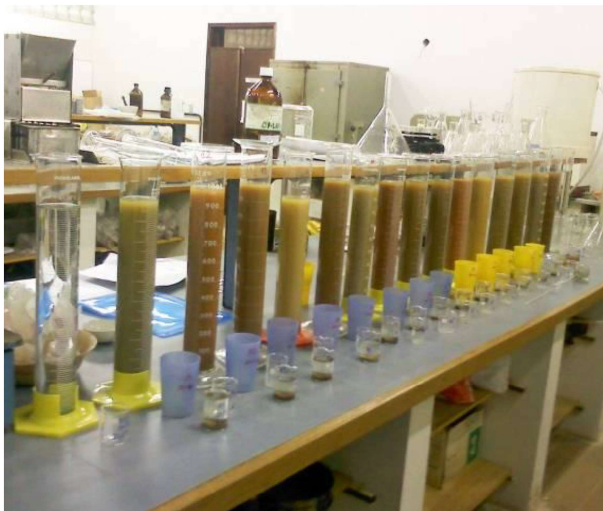
Figura 28: Análise da granulometria dos finos, silte e argila, por pipetagem, segundo o método da EMBRAPA (1997). Foto: Fábio Lima, 2010.
