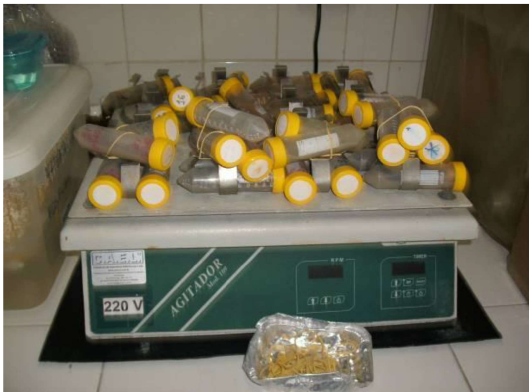
Figura 30: Amostras no dispersante químico e no agitador. Foto: Fábio Lima, 2010.
