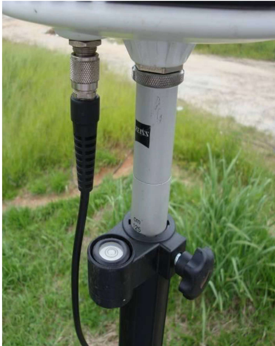
Figura 22: Nivelamento do DGPS. Foto: Fábio Lima, 2010.
