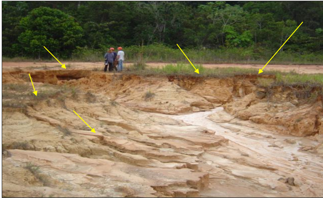
Figura 7.15: A existência de 5 ramificações nas cabeceiras de drenagem fornece à Voçoroca, a configuração de uma pequena bacia de forma dendrítica. Em novembro de 2004, esta incisão havia transportado cerca de 3.800m 3 de sedimentos que se distribuíram tanto na parte interna como dentro do rio Urucu.
