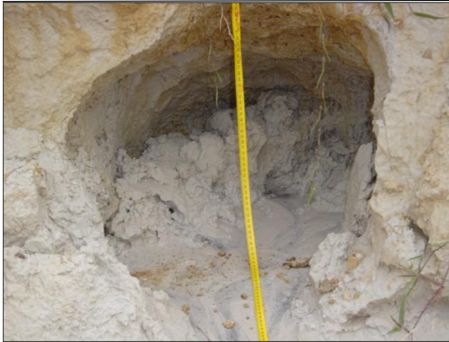
Figura 7.18: Alcovas de regressão, feição erosiva que aparece em vários pontos da incisão. Com a evolução destas pode ocorrer o desmoronamento do material acima e contribuir assim para o aumento das dimensões da voçoroca.
