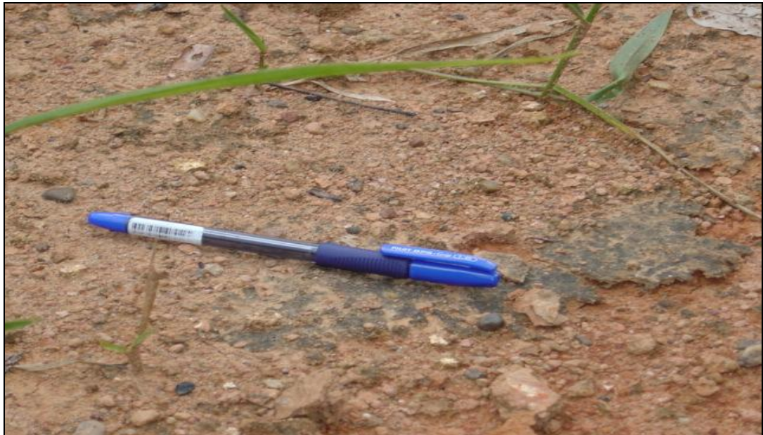
Figura 5.8: A formação de crostas na superfície do solo diminui a taxa de infiltração e proporciona aumento dos fluxos superficiais.
