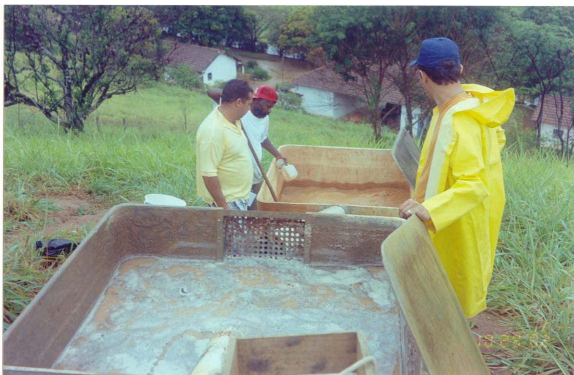
Figura 4.5. Medição da perda de solos realizada diretamente nas caixas coletoras.
