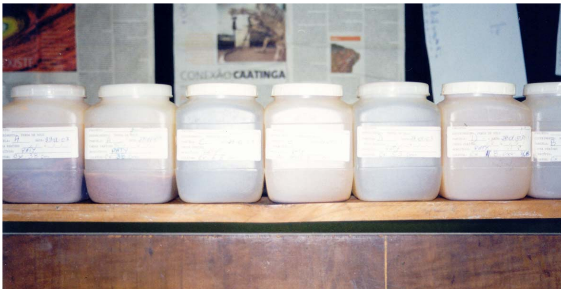
Figura 4.6. Detalhe dos potes utilizados para coleta dos sedimentos, onde eram registrados a parcela, data, horário e altura da caixa/balde durante as coletas de perda de solo.
