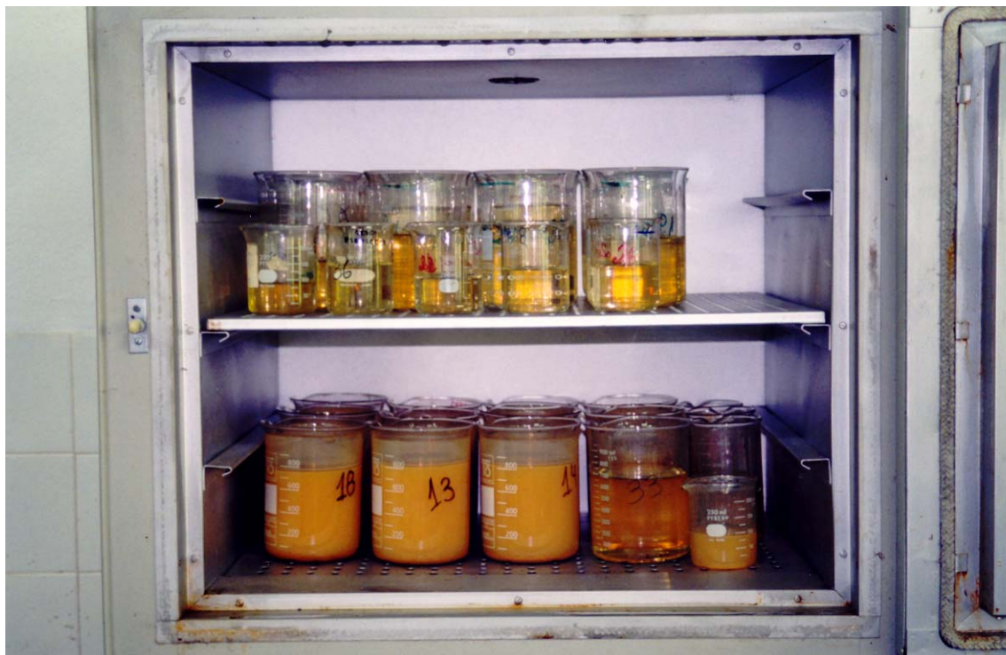
Figura 4.8. Detalhe dos beckeres dentro da estufa para o início do processo de secagem dos sedimentos.
