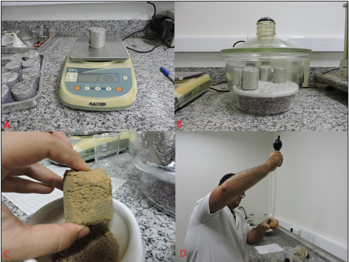
Figura 17. Análise das amostras indeformadas para determinação da densidade aparente e porosidade. A) Pesagem da amostra úmida com o anel; B) Amostras no anel volumétrico em dessecador após ter secado em estufa a 105° C ; C) Amostra indeformada seca; D) Amostra em balão aferido de 50ml em processo de adicionamento de álcool etílico. Foto: Espírito Santo, C. (2017).
