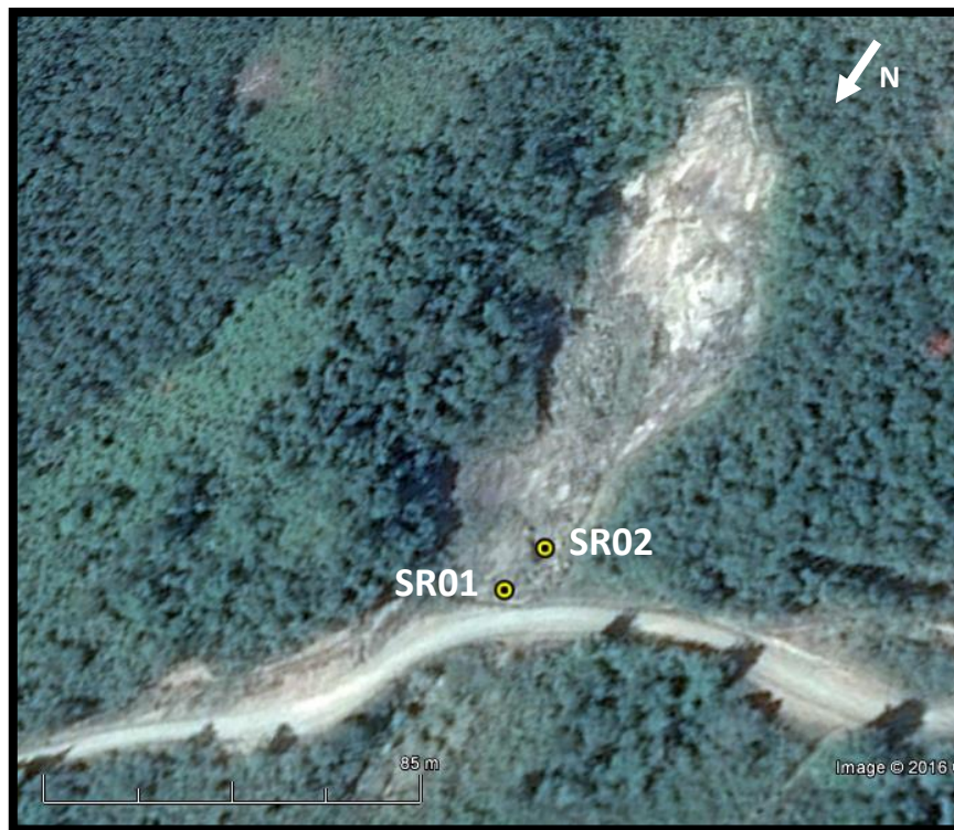
Figura 29: Localização das sondagens na baixa encosta e cicatriz do deslizamento; Reprodução de imagem Google Earth, 2014.
