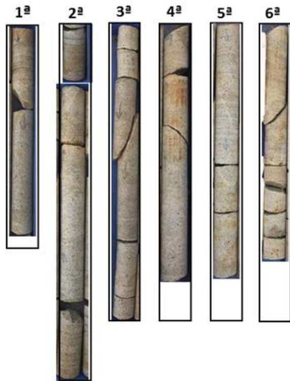
Figura 46: Testemunhos de SR02 separadas por manobra e organizados quanto à recuperação por manobra; perfil esquemático da distribuição espacial das fraturas e fissuras no testemunho.
