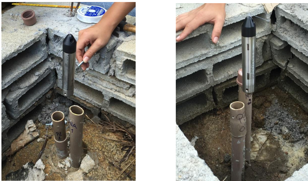
Figura 35: Transdutores de pressão sendo posicionados em PZ01 e PZ02 para monitoramento da carga de pressão.
