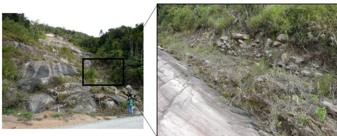
Figura 22: Saprolito de coloração cinza repleto de bloco de granito arredondados e alguns facetados, produto da alteração intempélica do granito.
