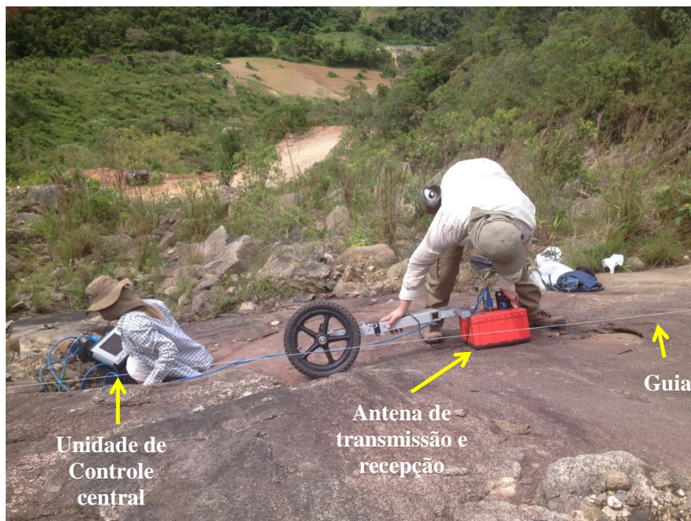
Figura 26: Perfil de GPR realizado em modo contínuo, em que as antenas são arrastadas sobre a superfície em análise. Um barbante foi utilizado como guia na direção da varredura por perfil.
