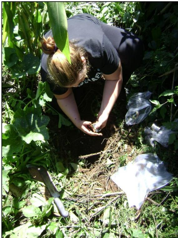
Figura 39: Coletas de amostras de solo indeformadas. Fonte: o autor (2016).
