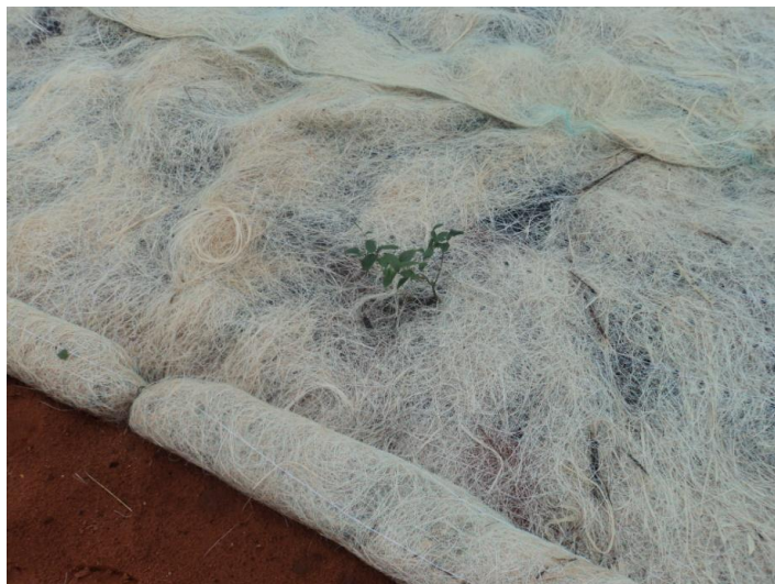
Figura 75. Detalhe de geotêxtil produzido com fibra de sisal. Foto: C.L. Vieira (Maio, 2015).
