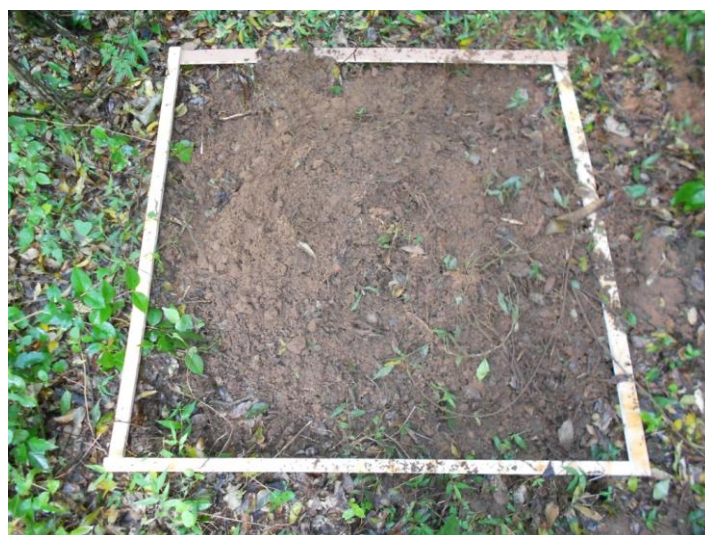
Figura 95. Gabarito de madeira com 1 m 2 utilizado para a coleta de topsoil e avaliações das UAs. Foto: C.L. Vieira (Setembro, 2015).
