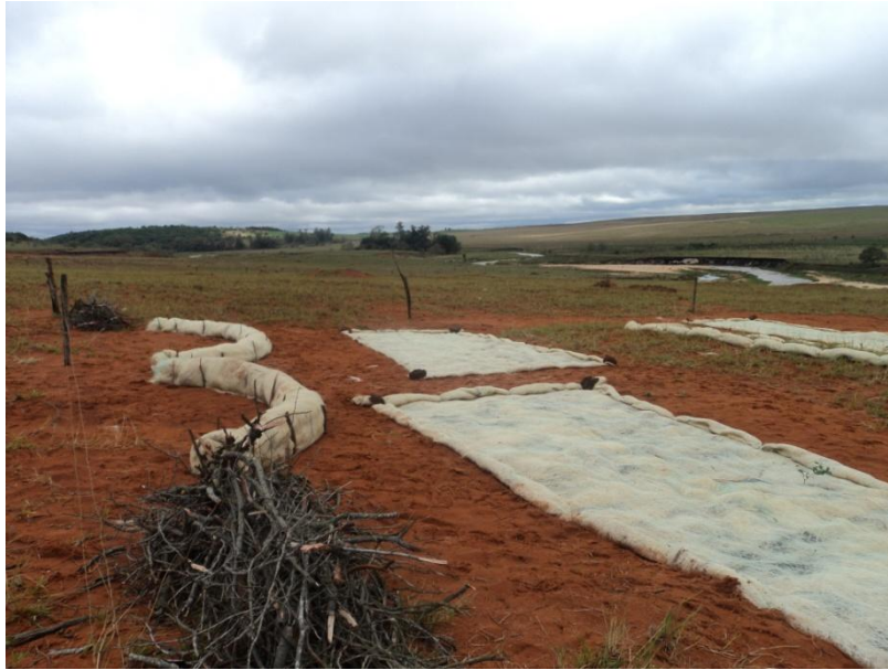
Figura 73. Vista geral Área Experimental I. Núcleos de galharia NG 2 (em primeiro plano) e NG1 (ao fundo), estruturas abertas em semicírculo para a estimativa de erosão e Unidades de Avaliação P2-ME (em primeiro plano), P1 SeM (à esquerda na foto) e P4 CrB (ao fundo e à direita na foto). Foto: C.L. Vieira (Maio, 2015).
