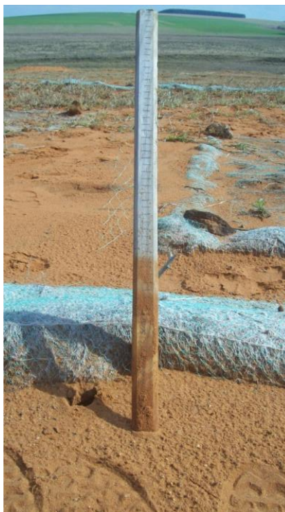
Figura 90. Régua de madeira para estimativa perda de solo por erosão hídrica superficial. Foto: C.L. Vieira (Julho, 2016).
