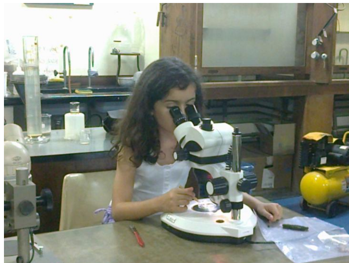
Figura 35. Análise de morfooscópica de sedimentos em microscópio estereoscópico binocular, laboratório do CECO/UFRGS. Foto: C.L. Vieira (Novembro, 2014).
