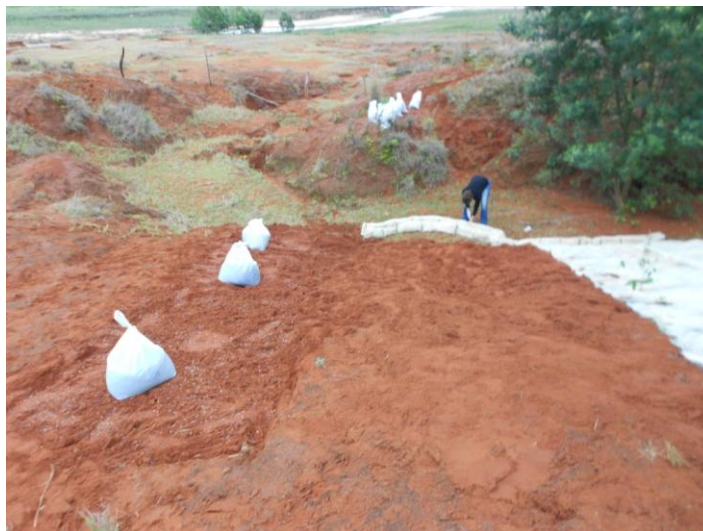
Figura 98. Implantação da parcela Testemunha (Ts) na Área Experimental II, sentido topo-base. Confecção de estrutura semicircular na base para estimativa de erosão. Foto: C.L. Vieira (Setembro, 2015).
