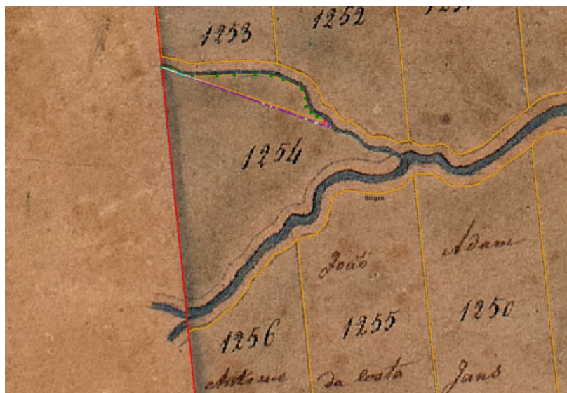
Figura 11 —Processo de vetorização dos prazos de terra da Planta Koeler.
