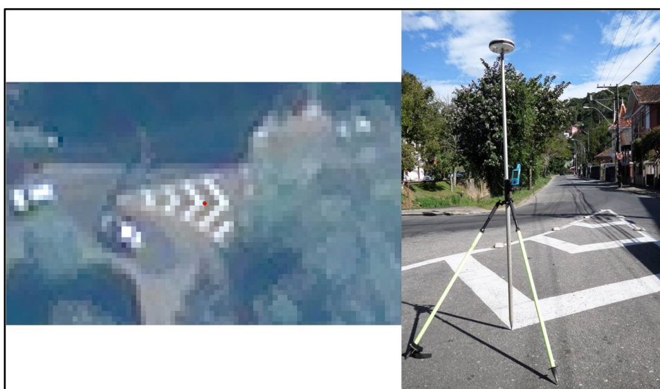
Figura 9 —Exemplo de feição identificável tanto na imagem, quanto em campo utilizada para posicionar receptor GNSS.
