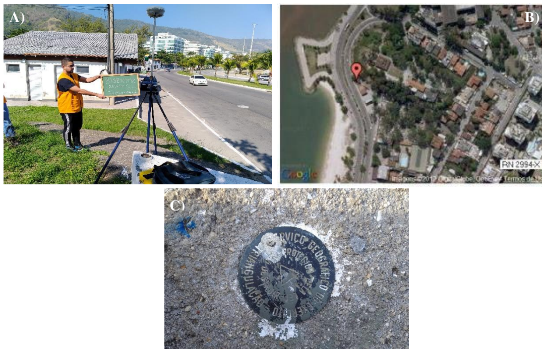
Figura 26 –Identificação da base 2994X (a- Localização da Base e equipamento GNSS Trimble R6, b – Posição da base em imagem do Google Earth c – Chapa Metálica 2994X)
