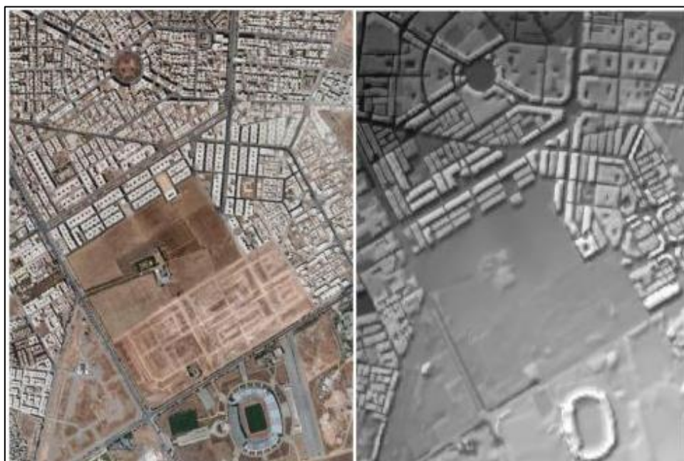
Figura 21 – Cidade tridimensional por Modelos Digitais. Imagem Worldview-2 a esquerda e o Modelo Digital de Elevação da mesma área (Fonte: El Garouani et.al 2014)
