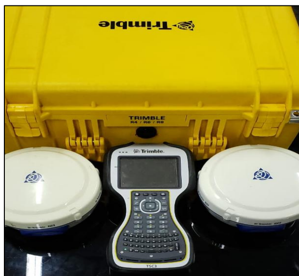
Figura 15 – Base, Rover e Coletora Trimble R6
